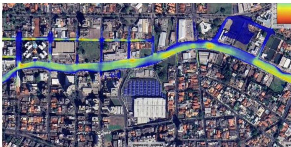
Figura 4.21 - Mapa de velocidades máximas do escoamento no trecho entre o exutório do córrego Lagoinha (lado esquerdo) e avenida dos Municípios (lado esquerdo).
