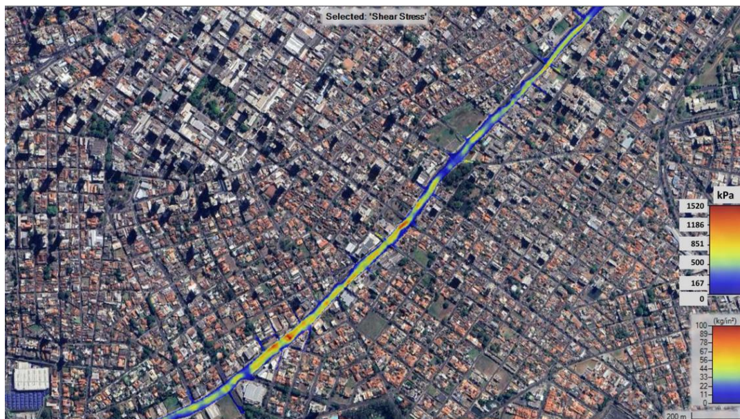
Figura 4.23 - Trecho crítico em relação ao arraste de veículo e destacamento de pavimentos.
