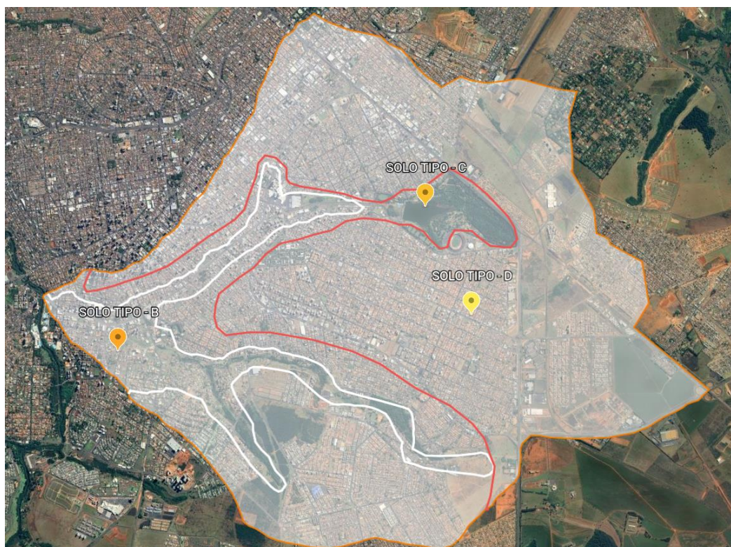
Figura 3.5 – Classificação hidrológica dos solos da bacia hidrográfica do córrego São Pedro - método SCS.
