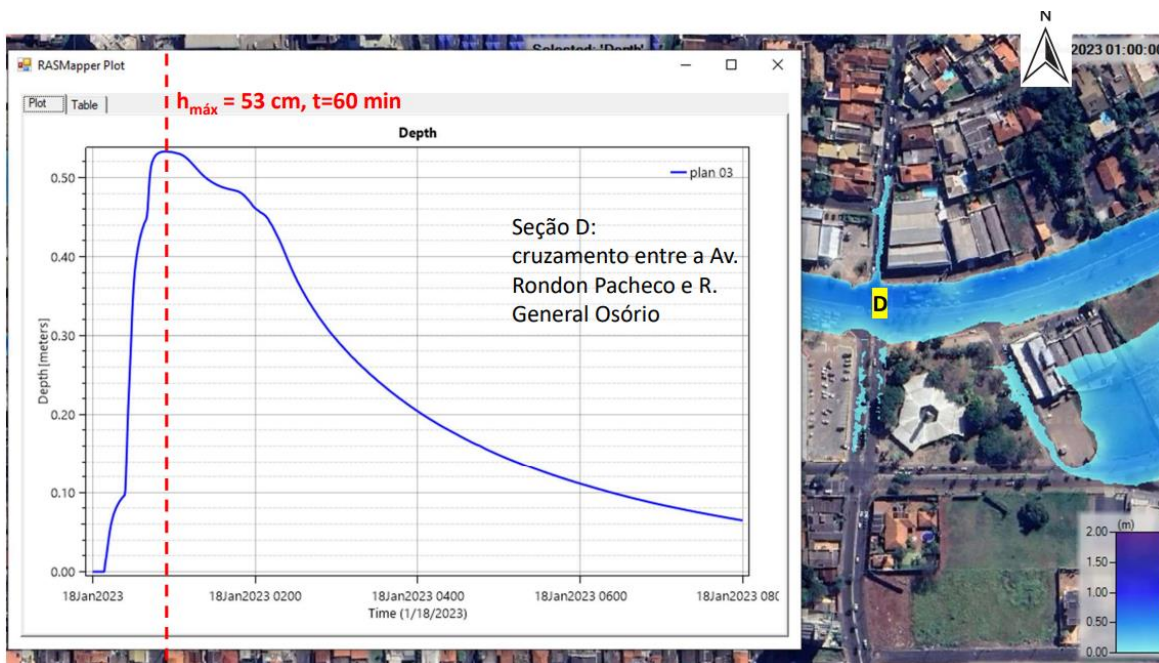
Figura 4.15 - Profundidade da lâmina de água no trecho de cruzamento da avenida Governador Rondon Pacheco com a rua General Osório.
