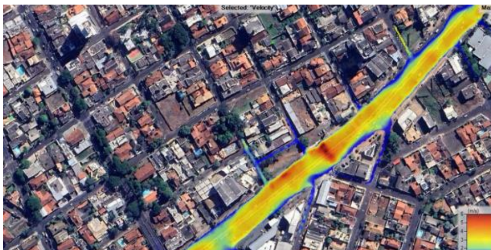
Figura 4.20 - Mapa de velocidades máximas do escoamento no trecho entre as ruas Javari (lado direito) e Raimundo P Carvalho (lado esquerdo).
