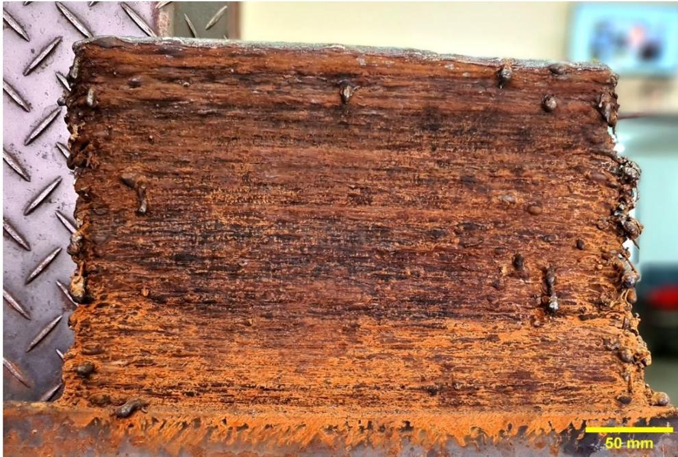
Figura 26. Parede em ER70S-3/ER80S-G em seu aspecto bruto após deposição
