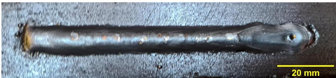
**Velocidade de Soldagem 1200 mm/min; Tensão de Alimentação 30 V**
