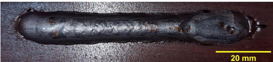
**Velocidade de Soldagem 1500 mm/min; Tensão de Alimentação 31 V**
