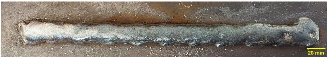
**Amplitude 8 mm; Passo 16 mm; parada de 0,2 s no meio de cada passo**
