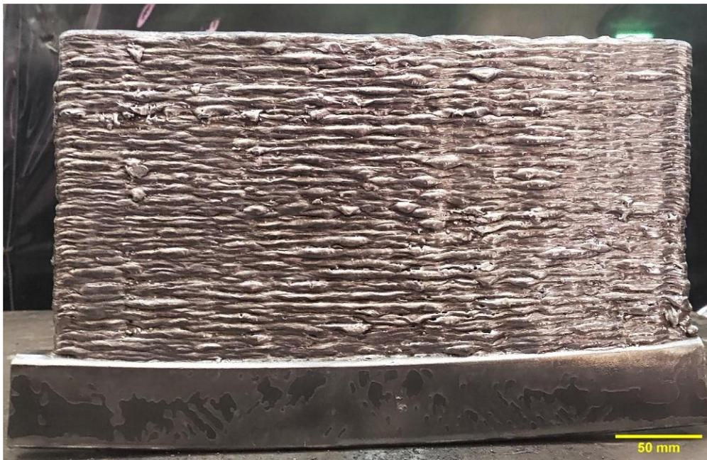
Figura 30. Parede em ER70S-3/ER110S-1
