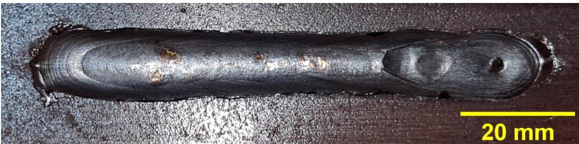
**Velocidade de Soldagem 1000 mm/min; Tensão de Alimentação 31 V**
