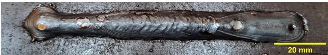
**Velocidade de Soldagem 1200 mm/min**
