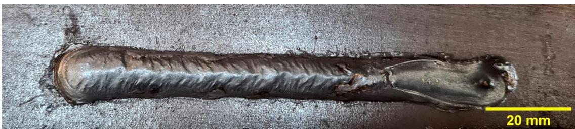
**Velocidade de Soldagem 1500 mm/min**
