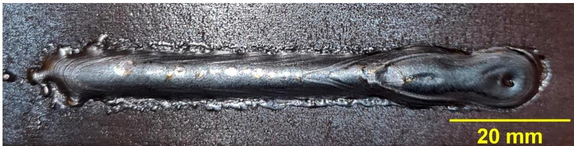
**Velocidade de Soldagem 1200 mm/min; Tensão de Alimentação 31 V**
