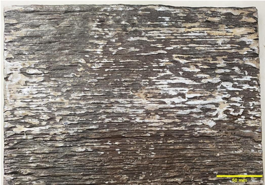
Figura 28. Parede em ER70S-3/ER80S-G após remoção de respingos e corte das extremidades e substrato
