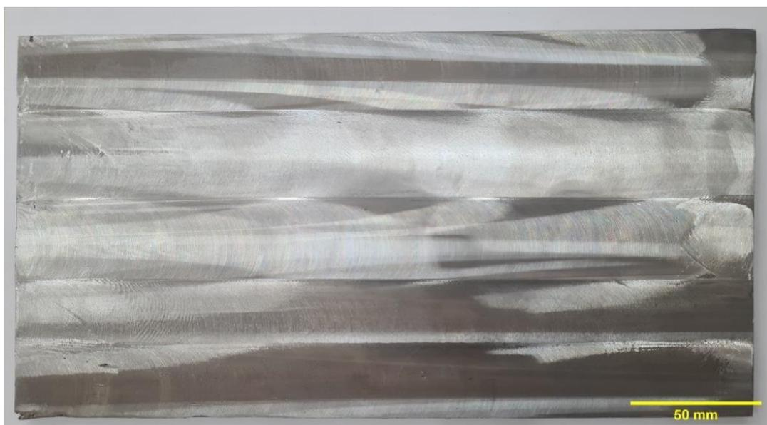
Figura 29. Parede em ER70S-3/ER80S-G após operação de faceamento
