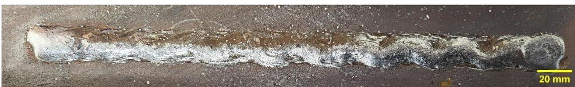
**Amplitude 8 mm; Passo 16 mm; parada de 0,2 s no meio de cada passo**
