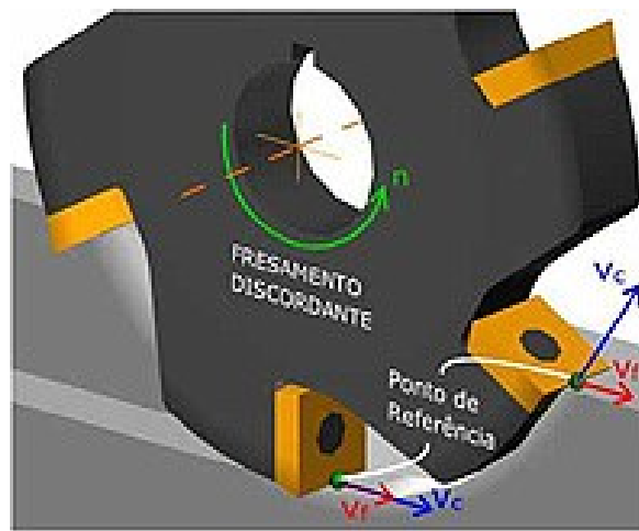
Figura 11 – Fresamento Discordante com parâmetros de sentido de rotação ( n ), velocidade de corte ( V_c ) e avanço ( V_f ) definidos. (CIMM, 2010)
