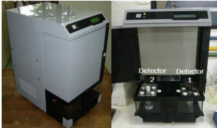
Figura 4. Equipamento de Eletroforese Capilar usado nos experimentos (CE-C 4 D).
