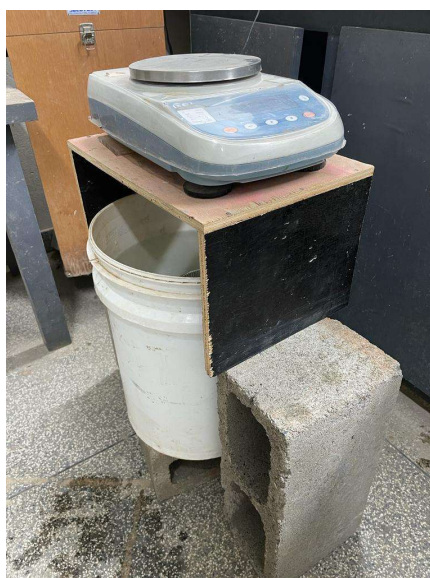
Figura 8: Determinação massa da amostra saturada imersa em água utilizando balança hidrostática
