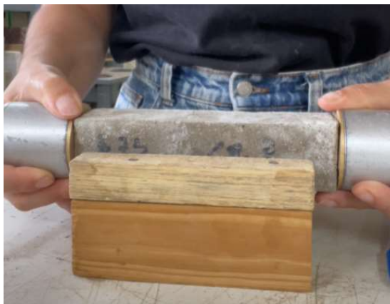
Figura 5: Ensaio de módulo de elasticidade dinâmico das argamassas
