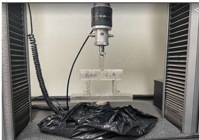
Figura 6: Ensaio de resistência à tração na flexão
