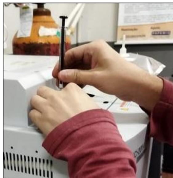
*Figura 28b: Injeção da Amostra de Syngas Coletada a 800 °C.*
