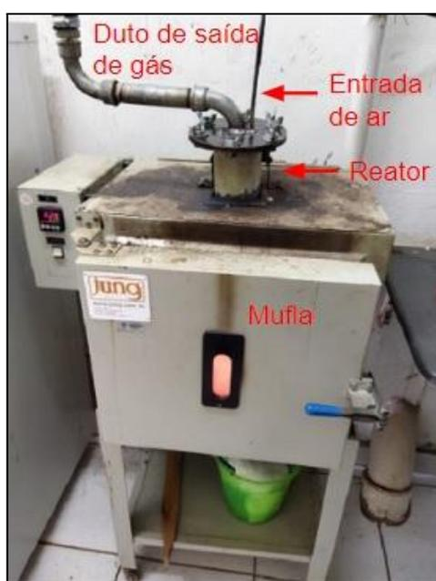
Figura 14: Reator de Gaseificação.
