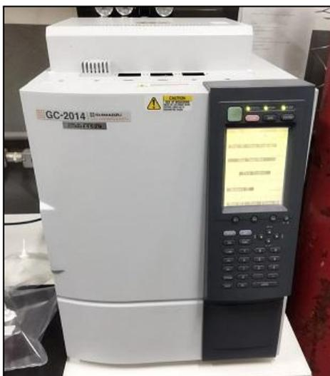
*Figura 26: Cromatógrafo Gasoso.*
