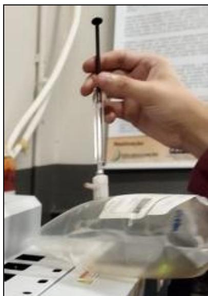
*Figura 28a: Remoção da Amostra de Syngas Coletada a 800 °C.*
