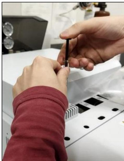
*Figura 27b: Injeção da Amostra de Syngas Coletada a 670 °C.*
