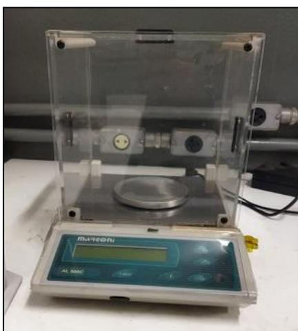
Figura 21: Balança de Precisão.
