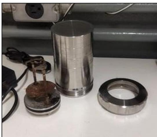
Figura 22: Recipiente Para Análise Calorimétrica.
