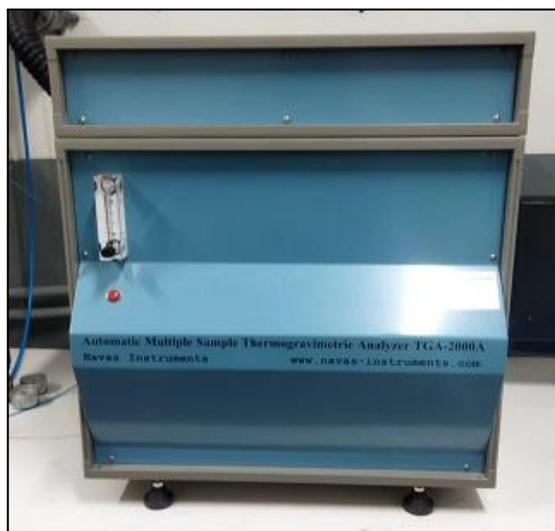
*Figura 19: Analisador TGA 2000A.*
