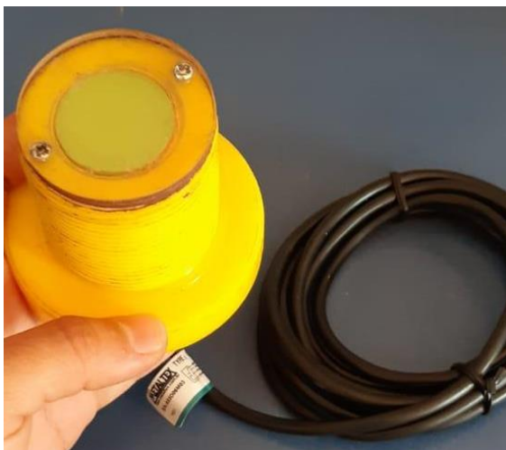
Figura 10 - Suporte de sensor de embuchamento proposto
