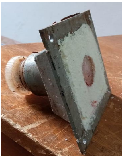
Figura 8 - Suporte de sensor de embuchamento proposto
