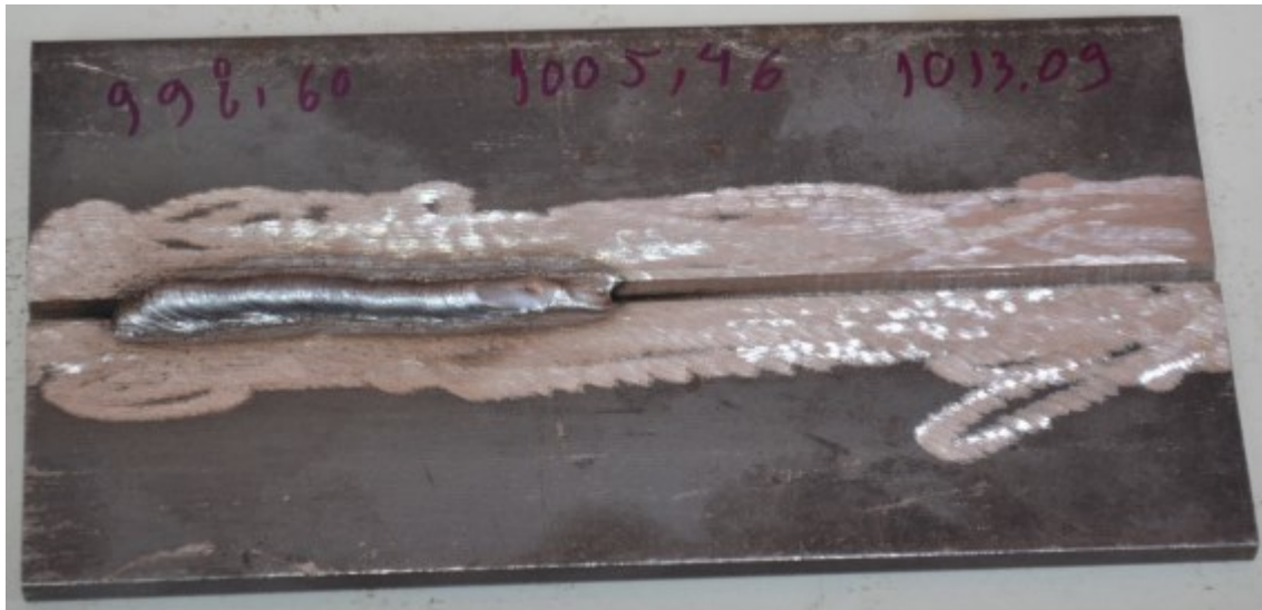
Figura 14 – Solda realizada sobre a solda anterior (GALVÃO, 2017)
