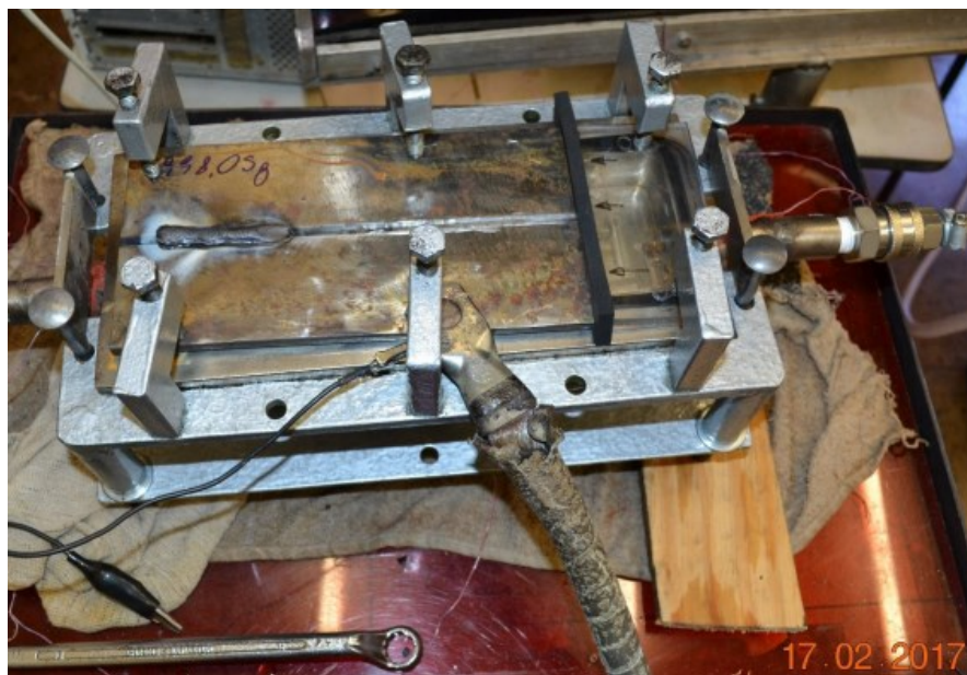
Figura 18 – Solda pelo processo SMAW durante a calorimetria (CARRARO, 2017)
