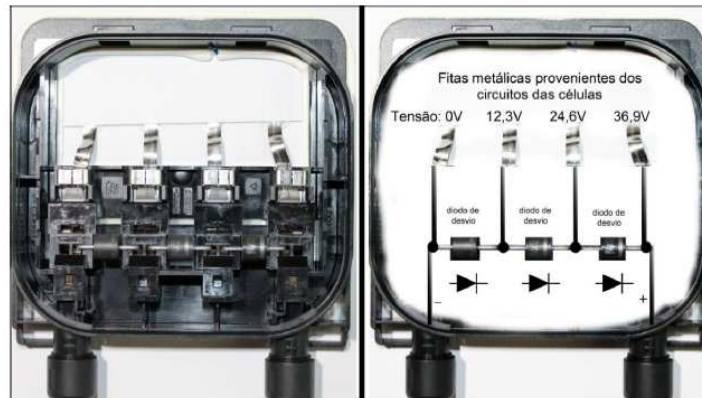
Figura 15 – Caixa de conexão
