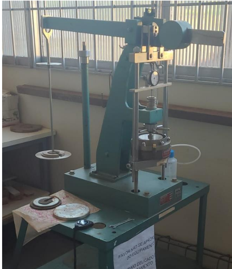
Figura 8 - Ensaio edométrico duplo em andamento (Fase de carregamento).
