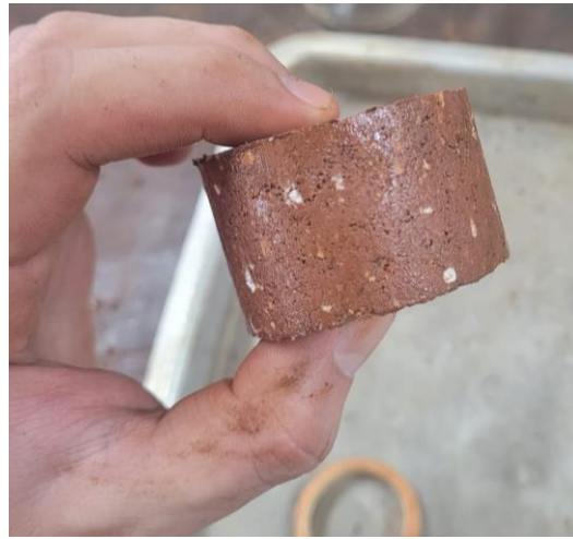
Figura 5 - Corpo de prova compactado para cravação em anel.
