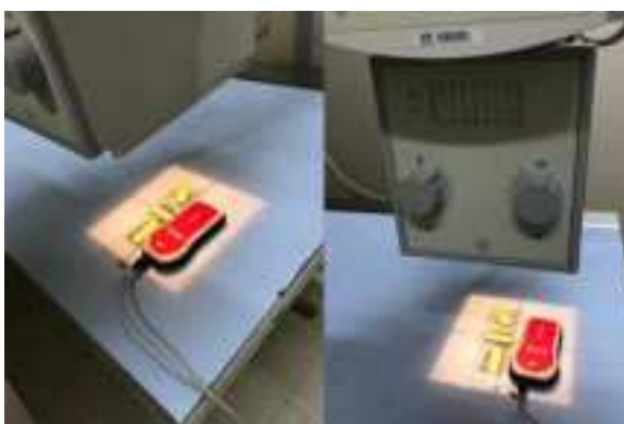
Figura 6: Disposição dos dosímetros e do detector PIRANHA ® para irradiação em um equipamento de radiodiagnóstico.
