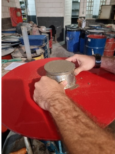
Figura 8 – Tronco de cone preenchido e arrasado para ensaio de consistência na Flow Table
