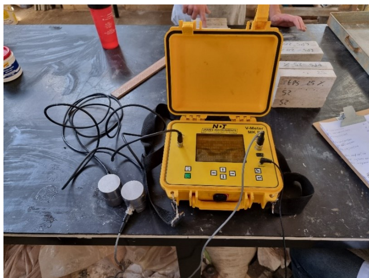
Figura 4 – Equipamento utilizado para medição de velocidade de propagação de onda
