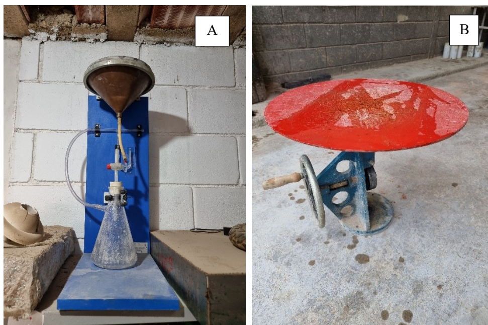
Figura 2 – a) Equipamento para ensaio de retenção de água; b) Flow Table
