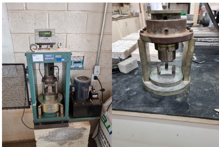
Figura 5 – Prensa e suporte utilizado para rompimento na flexão
