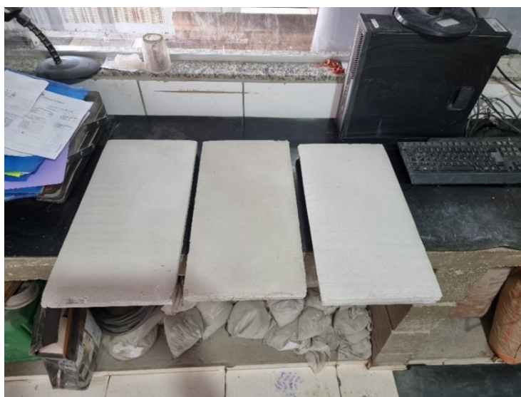
Figura 3 – Moldagens em substrato padrão das argamassas
