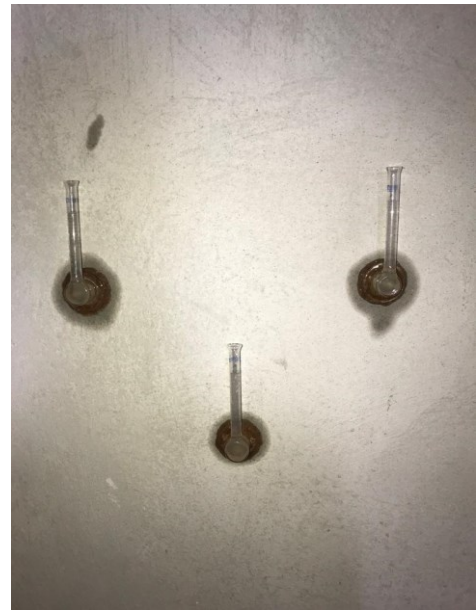
Figura 9: Disposição tubos de Karsten para ensaio de revestimento interno
