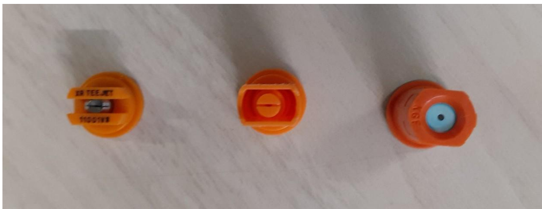
Figura 2: Pontas de pulverização utilizadas. Em ordem (esquerda para direita): TeejetXR 11001, Agrotop Airmix 11001 e Kgf COAP 9001.
