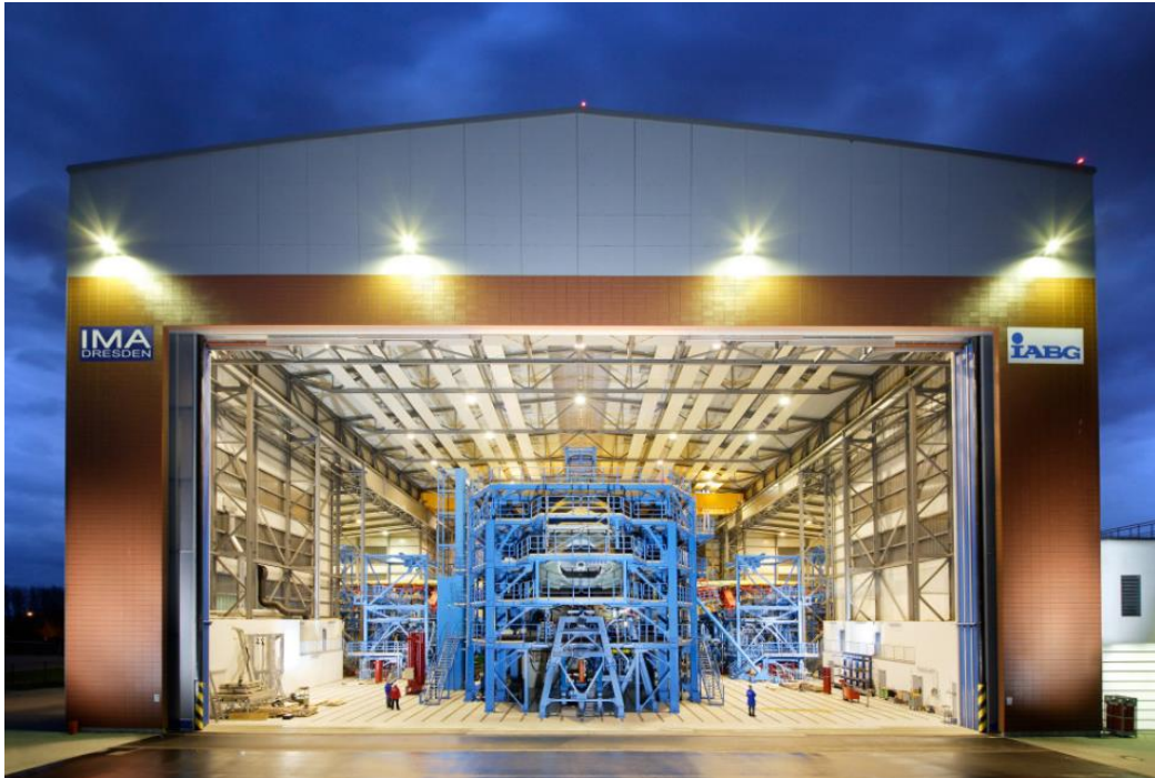
Figura 22 - Ensaio de fadiga full scale do Airbus A380-800. (IABG, 2013)
