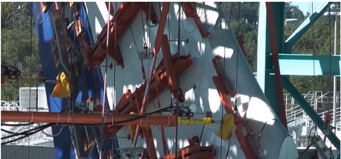
Figura 27 - Montagem dos dispositivos de aplicação de carga na empennagem vertical do ensaio de fadiga full scale do Boeing 787 Dreamliner. (Boeing, 2009)
