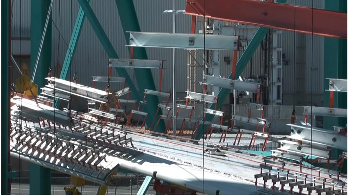
Figura 28 - Sapatas e árvores de carregamento sobre a semiasa do ensaio de fadiga full scale do Boeing 787 Dreamliner. (Boeing, 2009)
