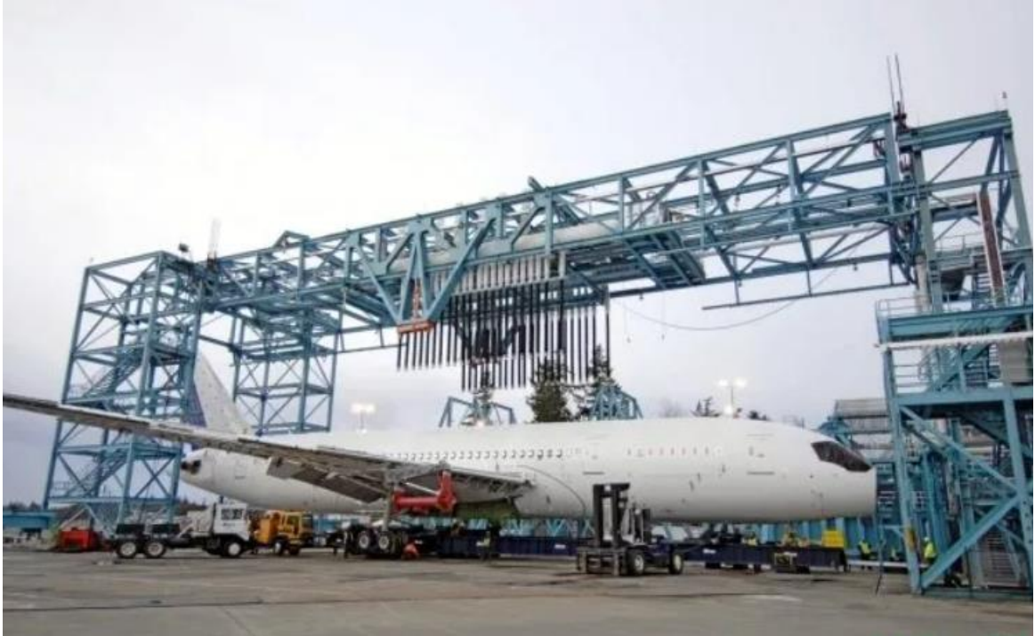
Figura 24 - Posicionamento da fuselagem do Boeing 787 Dreamliner para o ensaio de fadiga full scale . (Boeing, 2009)
