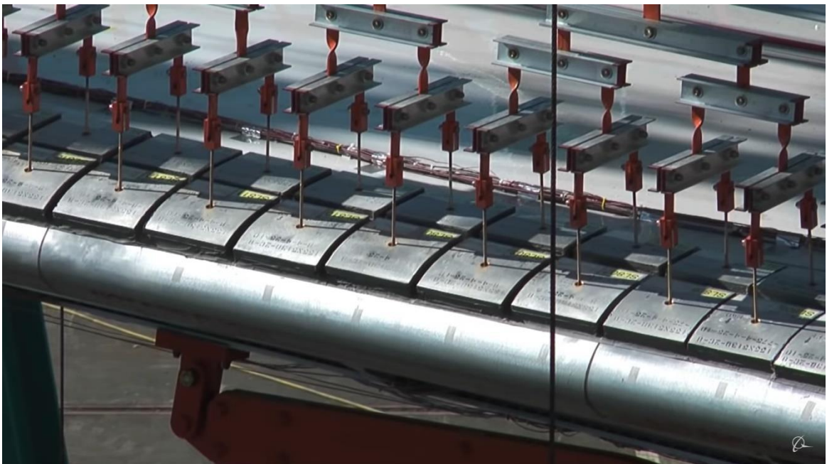
Figura 29 - Montagem das sapatas e árvores de carregamento sobre a semiasa do ensaio de fadiga full scale do Boeing 787 Dreamliner. (Boeing, 2009)
