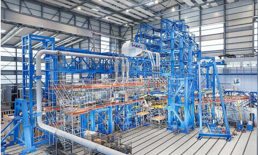
Figura 19 - Ensaio de fadiga full scale da fuselagem completa do Bombardier C-Series/A220-100. (IABG, 2018)
