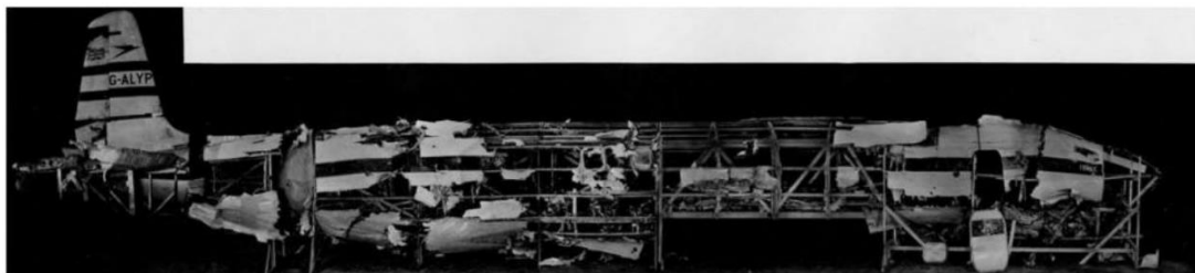
Figura 7 - Reconstrução da estrutura do Comet G-ALYP a partir dos destroços encontrados durante a investigação. ( lessonslearned.faa.gov )
