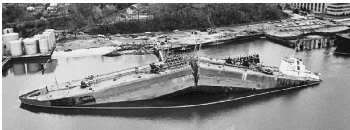
Figura 1 - Navio tanque ( Liberty-ship ) que fraturou de maneira frágil. (CALLISTER, 2015)
