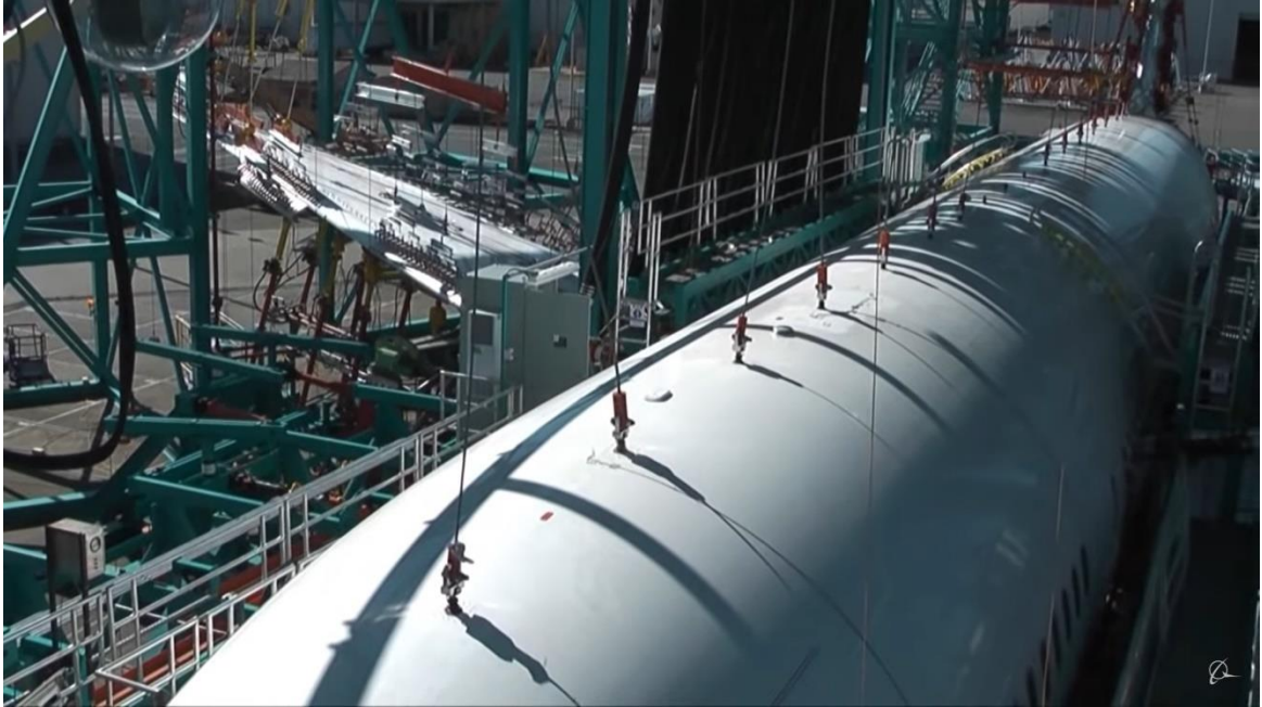
Figura 26 - Montagem dos dispositivos de aplicação de carga no corpo de prova do ensaio de fadiga full scale do Boeing 787 Dreamliner. (Boeing, 2009)
