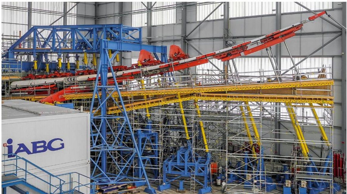
Figura 21 - Dispositivos flexionando a semiasa esquerda no ensaio de fadiga full scale do Airbus A350-XWB. (IABG, 2014)
