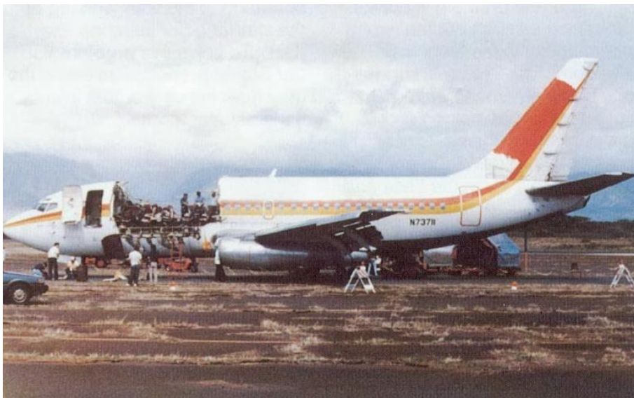
Figura 15 - Boeing 737 da Aloha Airlines logo após o acidente. (Wanhill, 2002)
