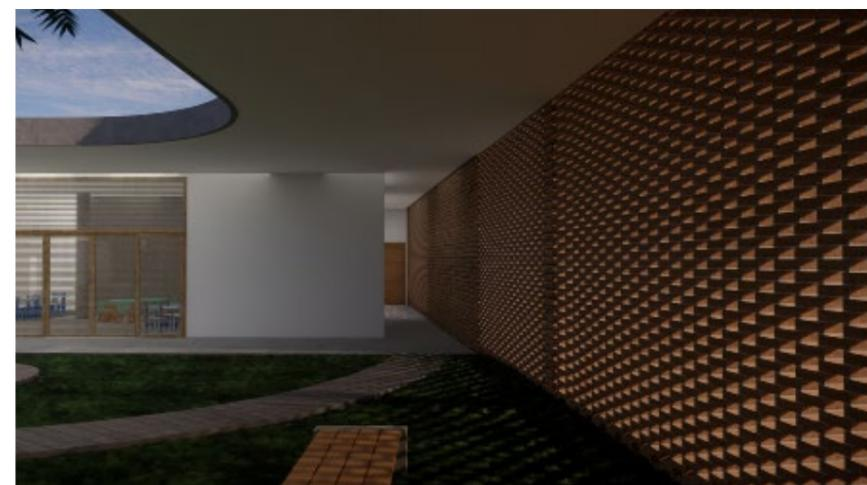
Os tijolos adquiriram funções estéticas e de conforto no projeto a partir dos cobogós do muro e da parede dos vestiários, na qual foi especificado um “cobogó degradê” **(Ver detalhes na prancha 6/7)**
