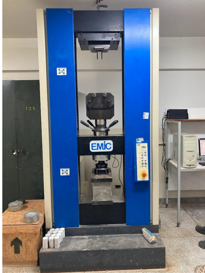
Figura 15 - Prensa usada no ensaio de resistência à compressão
