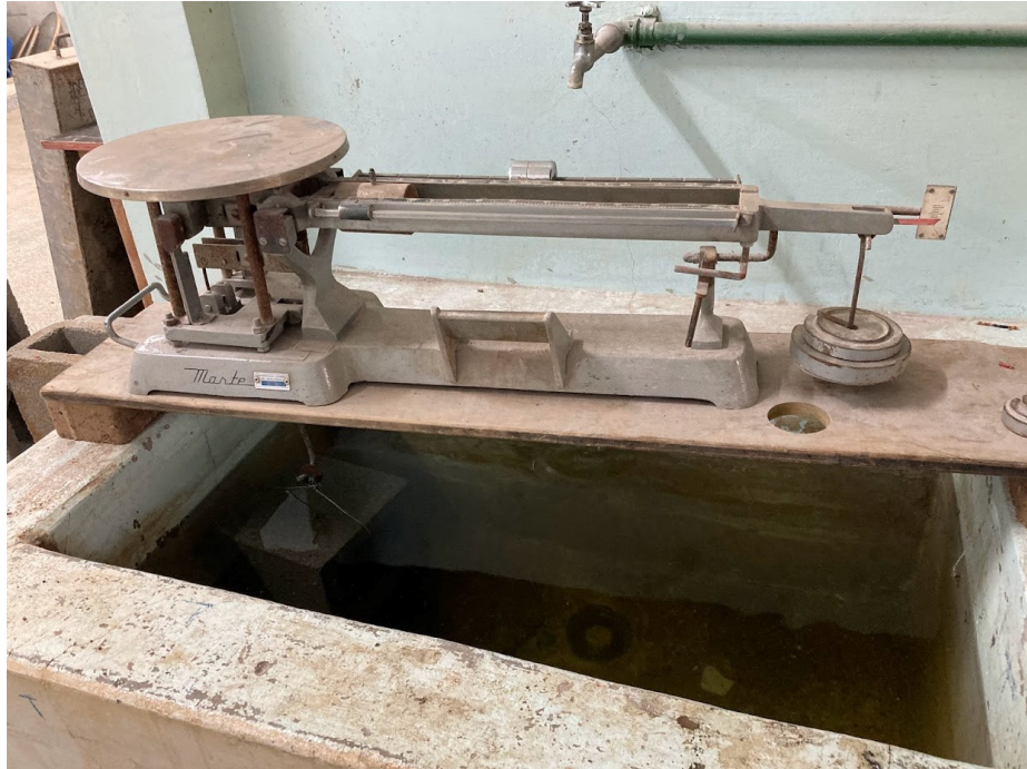
Figura 12 - Ensaio de absorção de água em bloco de concreto com uso de balança com adaptação hidrostática
