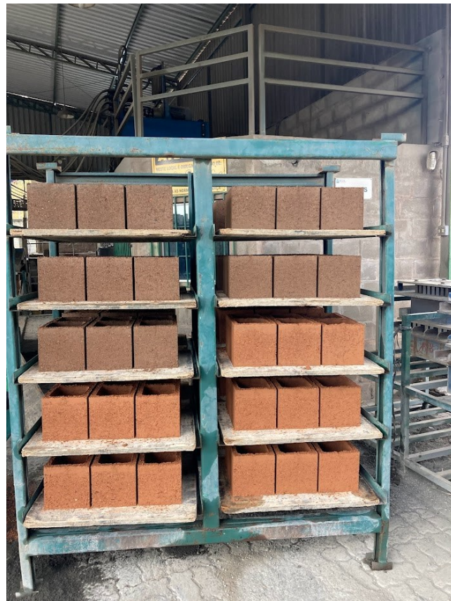
Figura 7 - Blocos após moldagem
