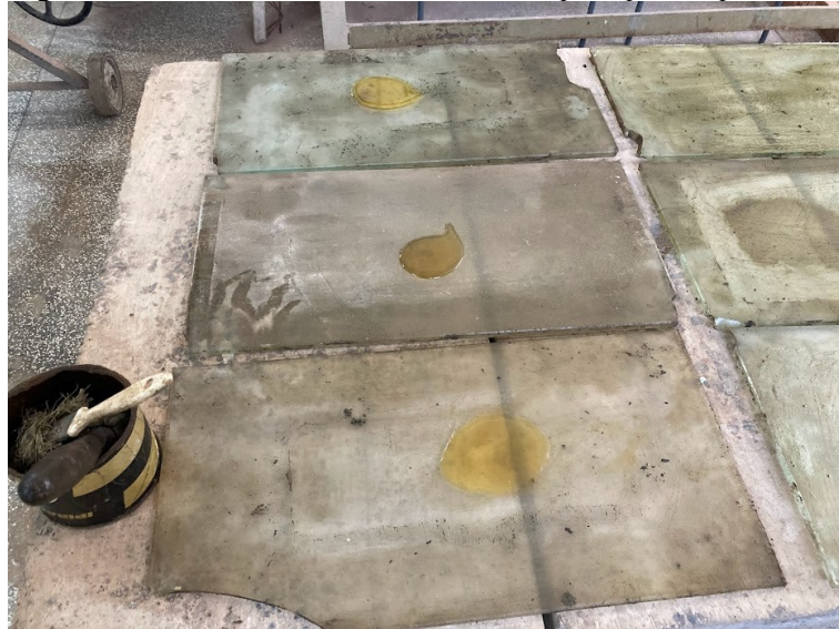
Figura 16 - Vidros untados usados como apoio para capeamento
