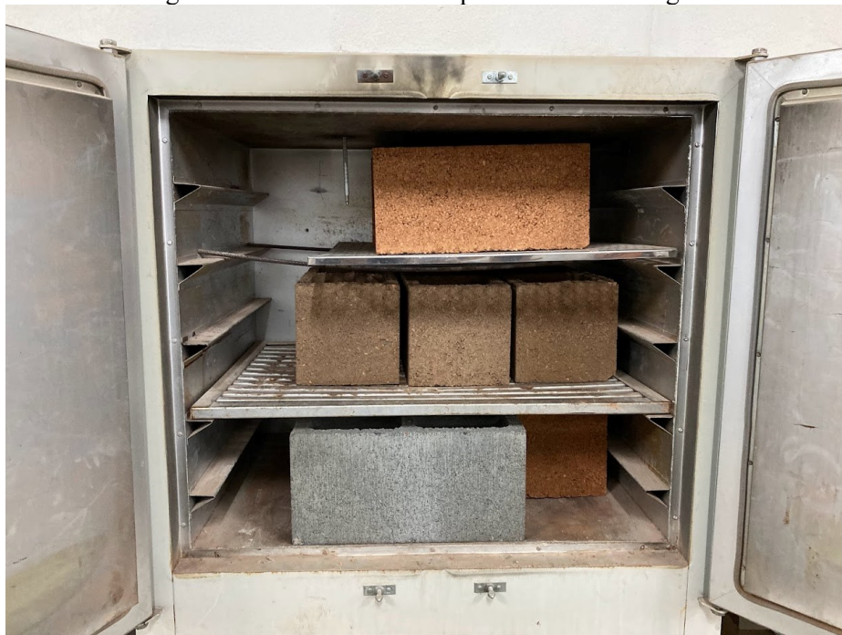
Figura 13 - Blocos em estufa para ensaio de secagem
