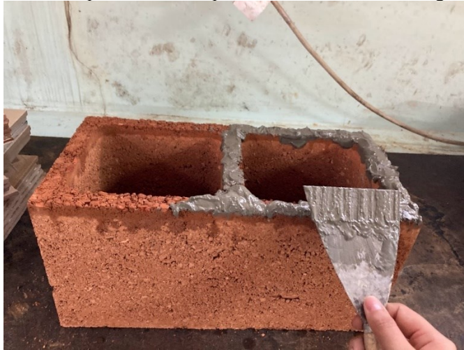
Figura 18 - Capeamento de topo de blocos com uso de argamassa
