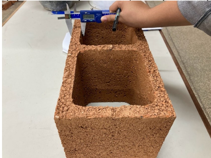
Figura 9 - Uso de paquímetro metálico para determinação das espessuras das paredes dos blocos
