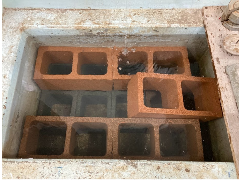
Figura 14 - Blocos imersos em água para determinação de massa saturada
