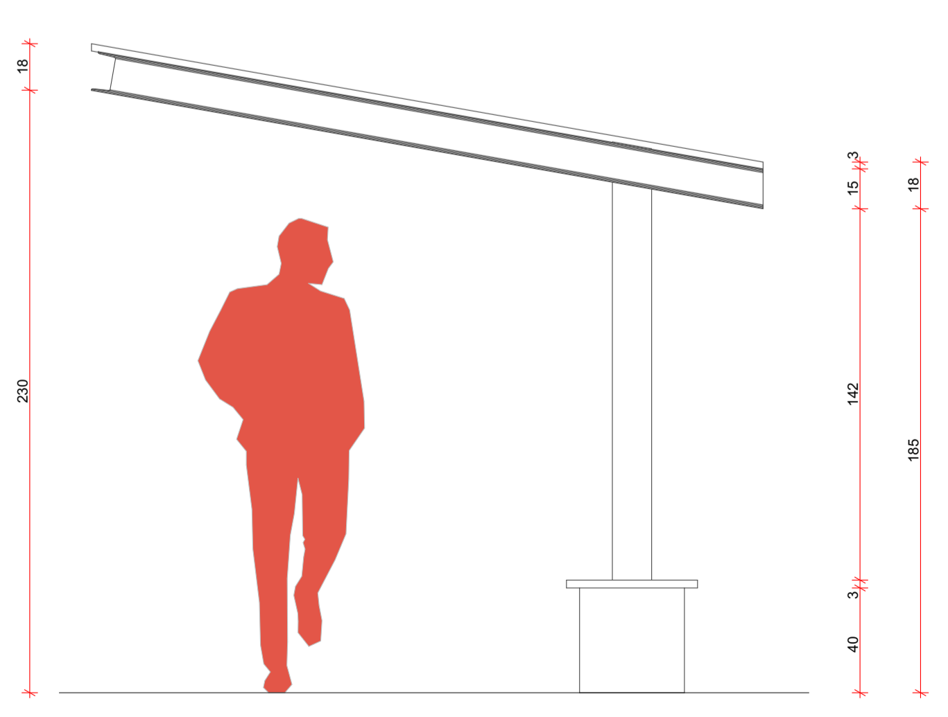
VISTA 02 - LATERAL - PONTO DE ÔNIBUS ESC.: 1:20
