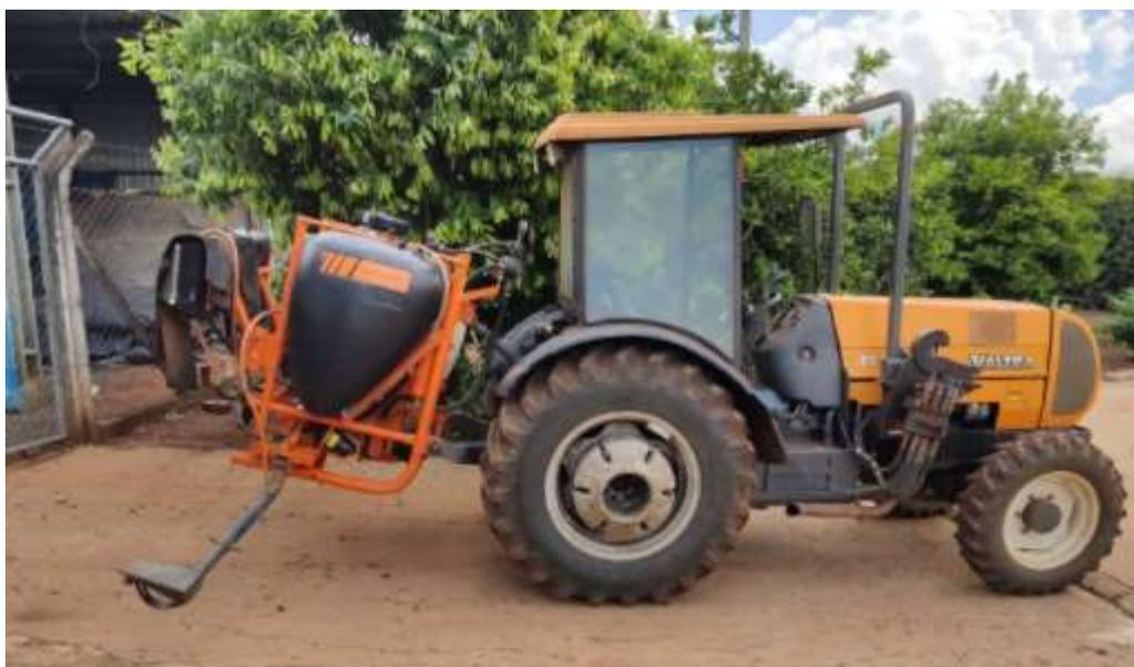
Figura 5. Conjunto utilizado para aplicação via drench contínuo.
