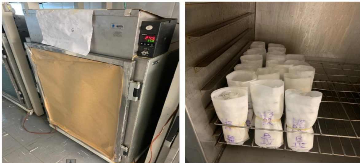
Figura 3 e 4. Germinador do tipo Mangelsdorf e distribuição dos rolos no germinador. Fonte: FRANCO,A.L.S.,2022.
