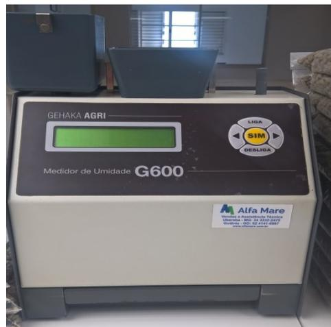
**Figura 3.** Medidor portátil de umidade de grãos. Fonte: Hanna Sugawara
