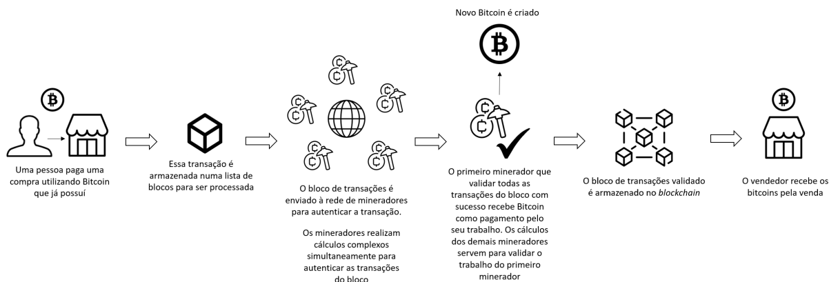
Figura 1 – Fluxo de Mineração do Bitcoin. - Fonte: Do Autor
