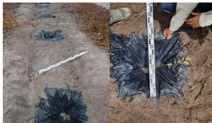
Figura 5 - Lonas colocadas para coleta de água por bacia
