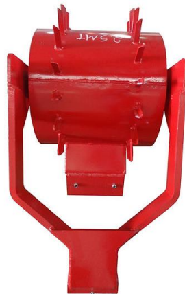
Figura 7 - Exemplo de marcador de cova usado no prepara de bacias mecanizadas Fonte: Bizmaq
