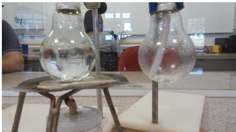
Figura 6: O kit de arraste a vapor com o uso de lâmpadas
