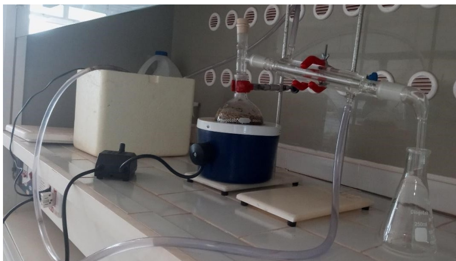
Figura 3: Montagem do equipamento de hidrodestilação com materiais de laboratório e materiais alternativos
