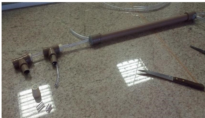
Figura 7: Condensador feito de cano de PVC e mangueiras
