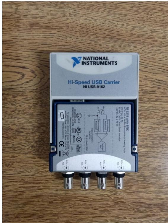
Figura 3.7 – Placa de aquisição National Instruments NI-USB9162.
