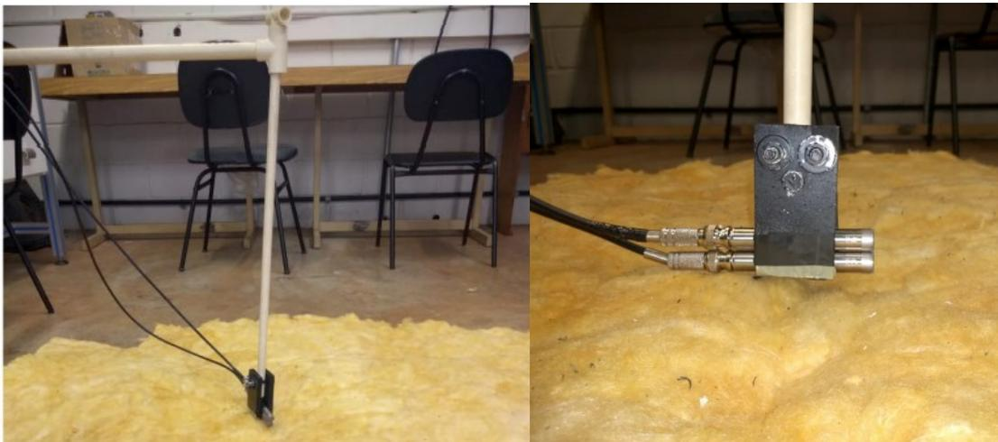
Figura 3.13 – Estrutura desenvolvida para posicionamento dos microfones para a medição do coeficiente de absorção *in situ* com Ruído Ambiente Anônimo.
