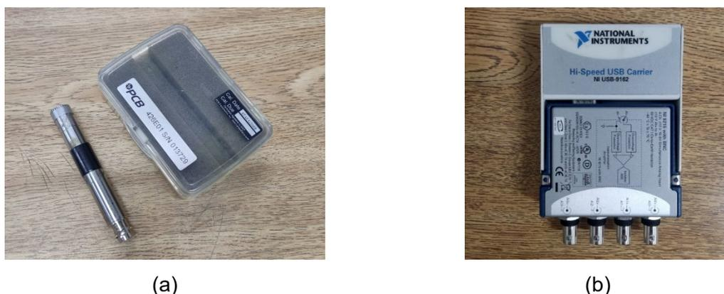
Figura 5.3 – Equipamentos utilizados no procedimento experimental. (a) Microfone de  $\frac{1}{2}$  polegada PCB 426E01 pré-amplificado; (b) Placa de Aquisição da *National Instruments*, (Modelo NI-USB9162).
