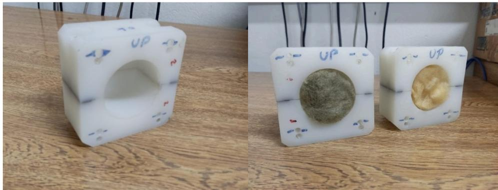
Figura 3.10 – Suporte das amostras a serem encaixadas no tubo de impedância, com e sem amostras.
