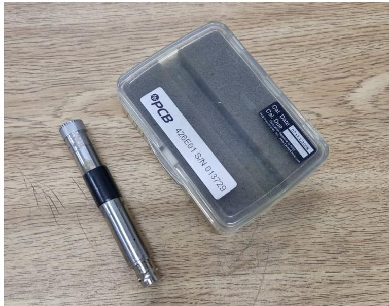
Figura 3.6 – Microfone de ½ polegada PCB 426E01.
