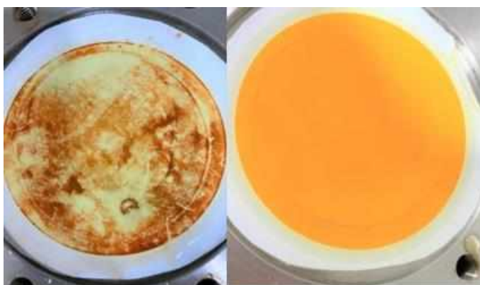
Figura - 20 Aspecto visual da membrana de 10 kDa após a ultrafiltração do: a) extrato aquoso e b) etanólico.
