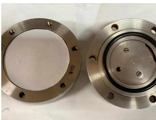
Figura - 11 Módulo e membrana polimérica de 10 kDa para sistema de ultrafiltração.
