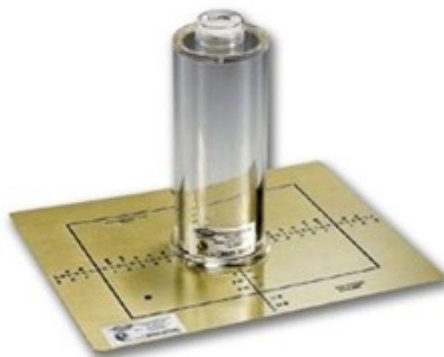
Figura 7 – Exemplo de dispositivo para teste de colimador e alinhamento do feixe de raios X.
