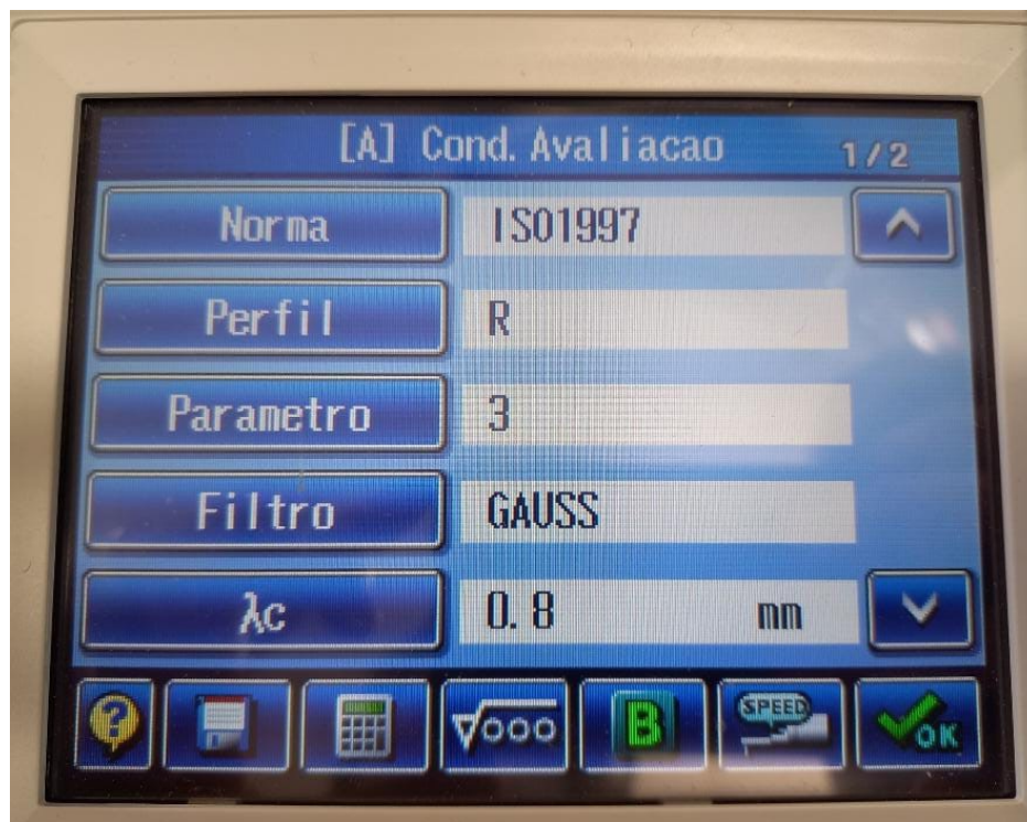
Figura 5: configuração do rugosímetro utilizado no teste de rugosidade superficial.
