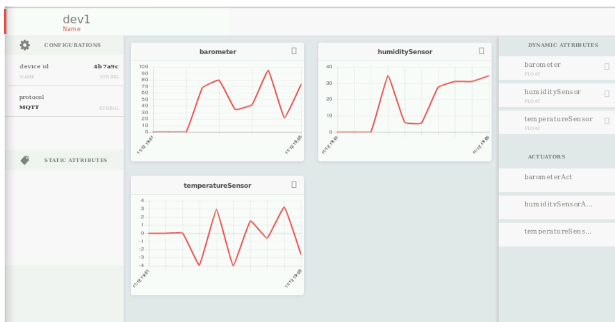
Figura 20 – Dados de uplink barômetro(pressão), temperatura e umidade no Dojo
