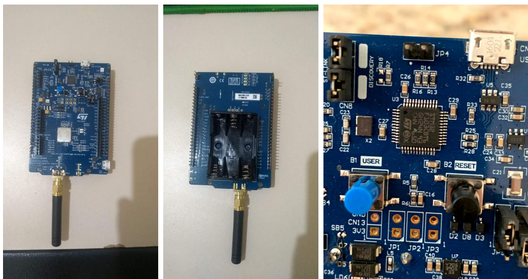
Figura 9 – Dispositivo STM32 usado como end device na rede LoRa.
