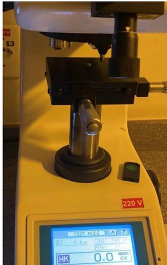
**Figura 5** - Cilindro de resina (2x5mm) submetido ao teste de Knoop.
