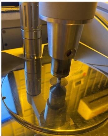
**Figura 6** - Cilindro de resina (2x4mm) submetido ao FTIR.
