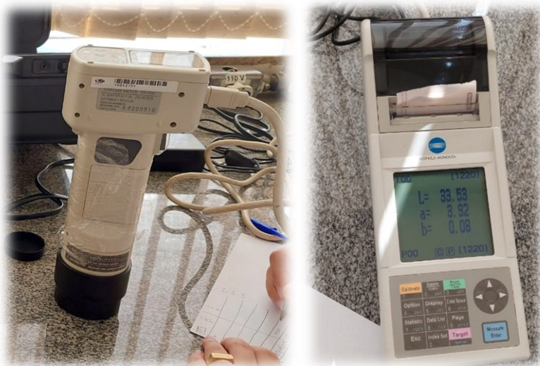
Figura 9: Avaliação do padrão de cor no colorímetro Minolta
