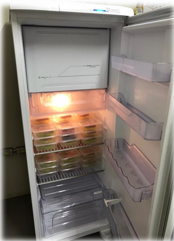
Figura 18 - Geladeira com amostras para análise para perda de peso durante a estocagem
