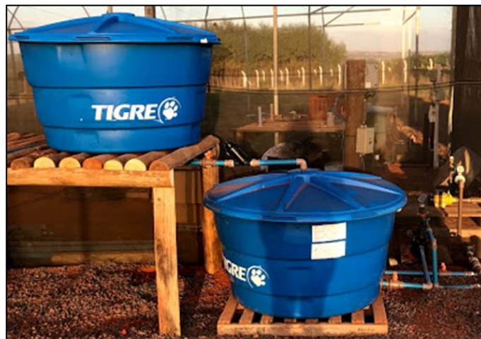
Figura 5. Estrutura para injeção de defensivos via água de irrigação (Quimigação).
