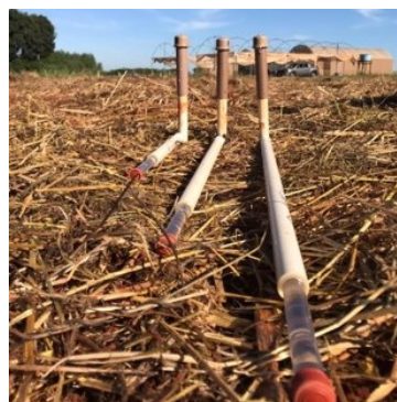
Figura 8. Profundidades de instalação das hastes tensiométricas.
