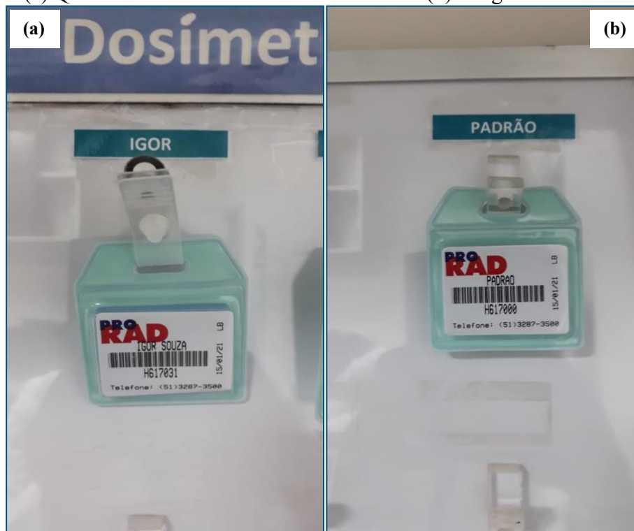
Figura 7: (a) Quadro com dosímetro de uso individual (b) imagem do dosímetro padrão
