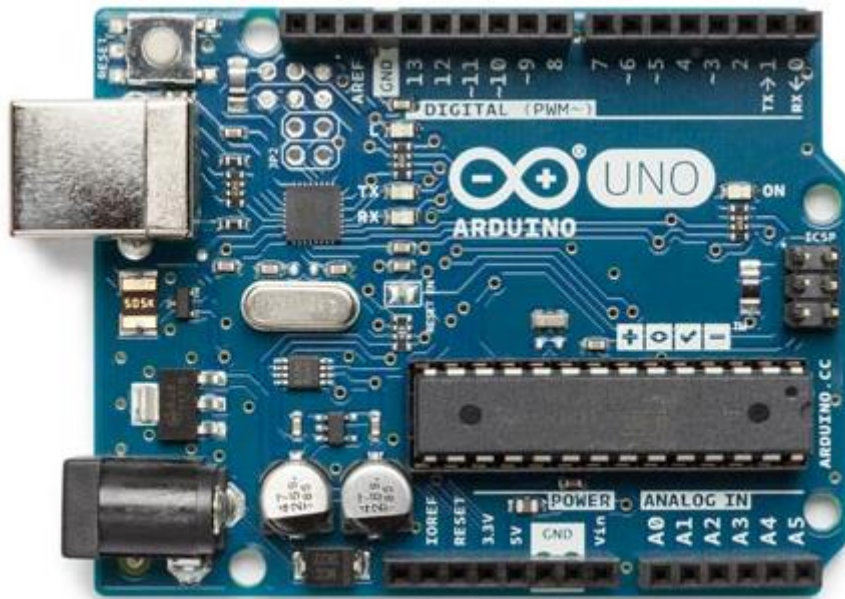
Figura 8. Arduino e seus componentes
