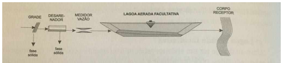
Figura 3 – Fluxograma de um sistema de lagoas aeradas facultativas.
