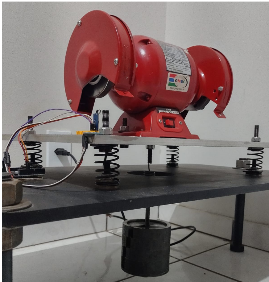
Figura 5.8 – Equipamento para análise de vibrações completo com maiores detalhes.
