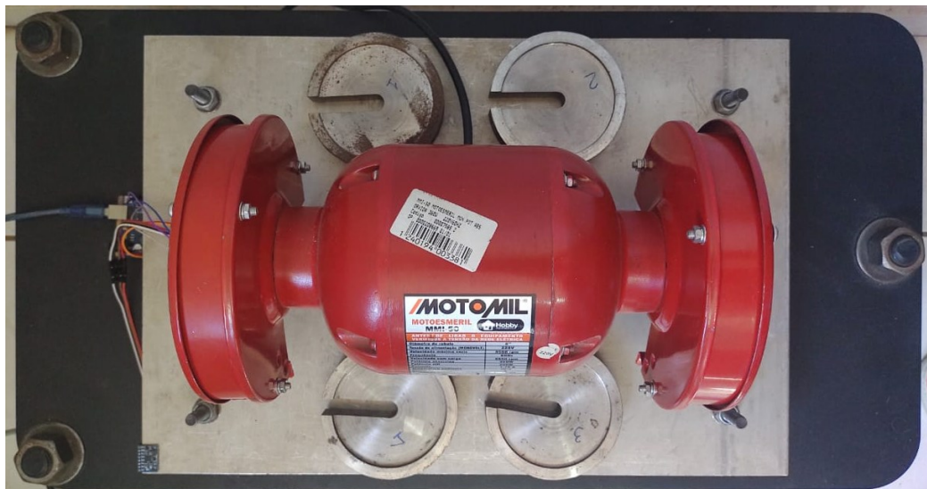
Figura 6.13 - Sistema com alteração de massa através da fixação de pesos utilizando fita dupla face sobre a chapa.
