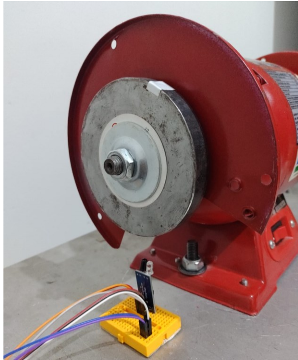
Figura 5.4 - Disco 2, fita reflexiva e sensor infravermelho de obstáculo, conectado a uma protoboard.
