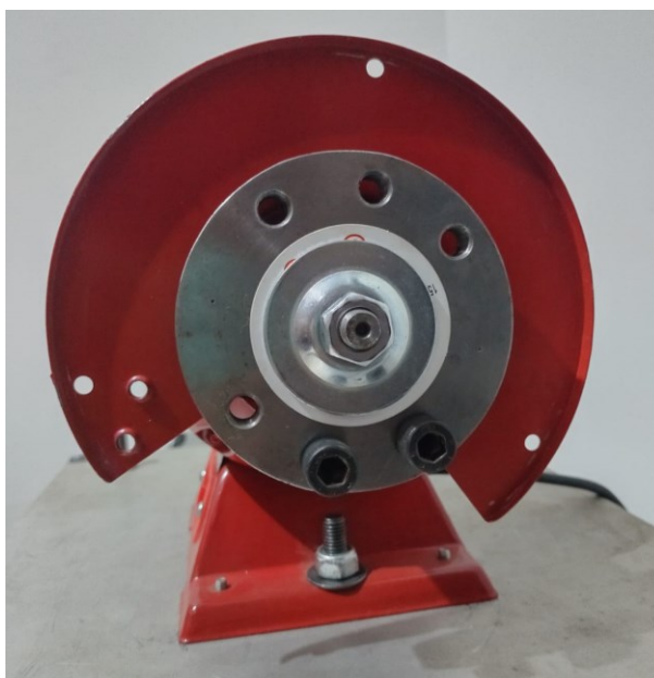
Figura 5.3 - Disco 1 com adição de massa a fim de gerar desbalanceamento.
