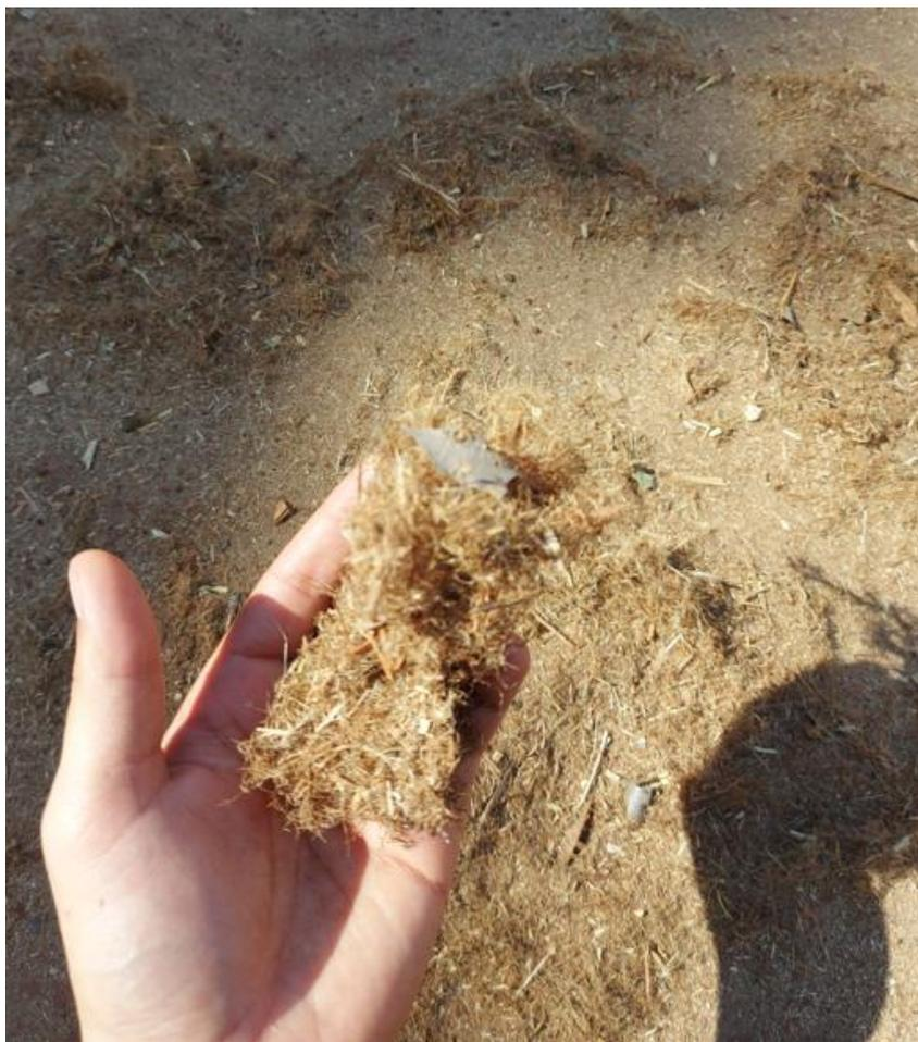
Figura 21: Resíduos liberados pelo cavaco de bambu no pátio, abaixo das correias transportadoras
