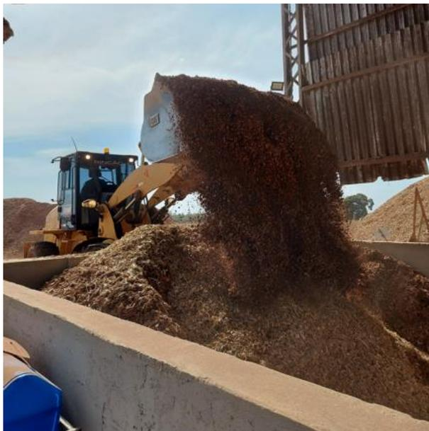
Figura 9: Cavaco de bambu sendo despejado na tremonha
