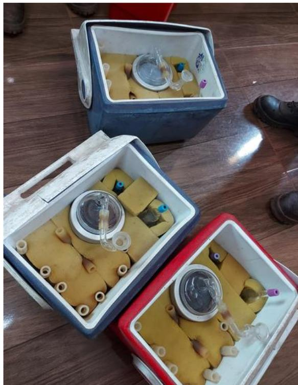
Figura 18: Filtros utilizados na análise de emissão de particulados para o mix de cavaco
