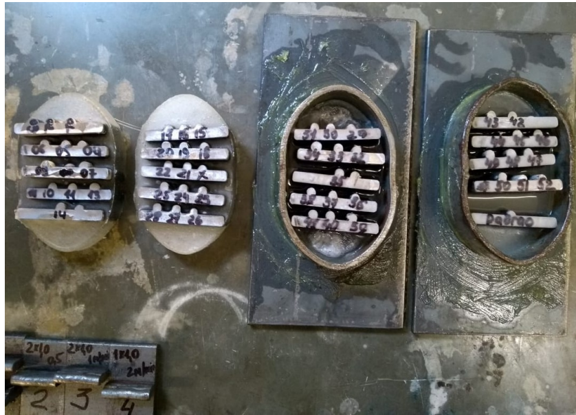
Figura 21 – Amostras agrupadas e preparadas para serem dispostas em resina.
