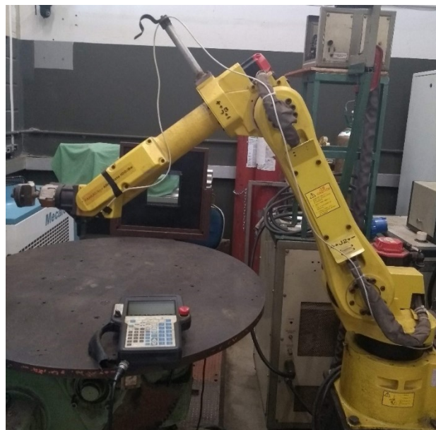
Figura 8 – Robô ARC Mate 100, Fanuc.
