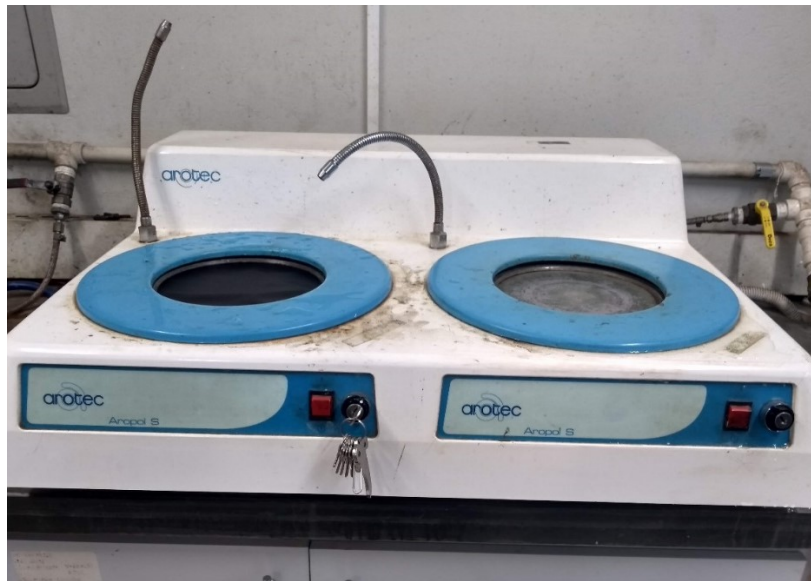
Figura 17 – Lixadeira Metalográfica dupla.
