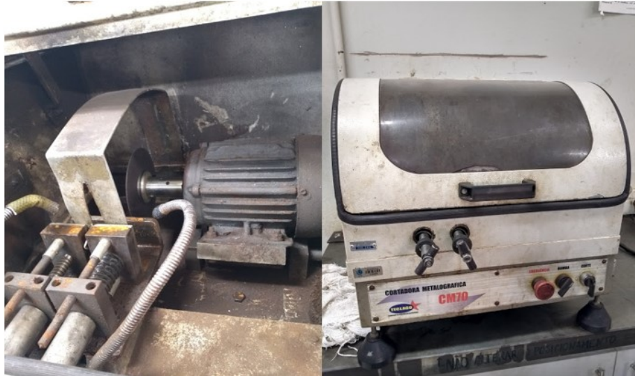
Figura 15 – Cortadora Metalográfica do laboratório de soldagem.
