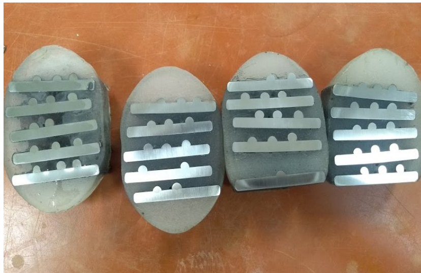
Figura 22 – Moldes após lixamento.
