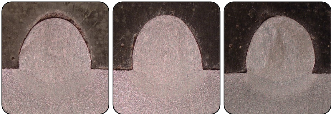
Figura 28 – Seção transversal de cordões de solda nas respectivas configurações: com arranjo de 1x0,8 mm nas velocidades de alimentação de 1,5 m/min, 2,0 m/min e 3,0 m/min (Adaptado de KOVALENKO, 2019).
