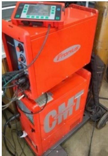
Figura 9 – Fonte de soldagem TPS 5000, Fronius com alimentador de arame.
