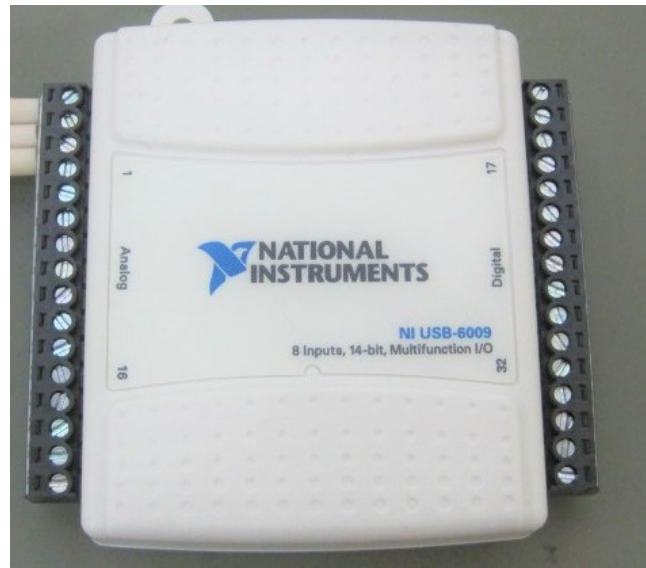
Figura 14 – Placa de aquisição de sinais - NI USB-6009.
