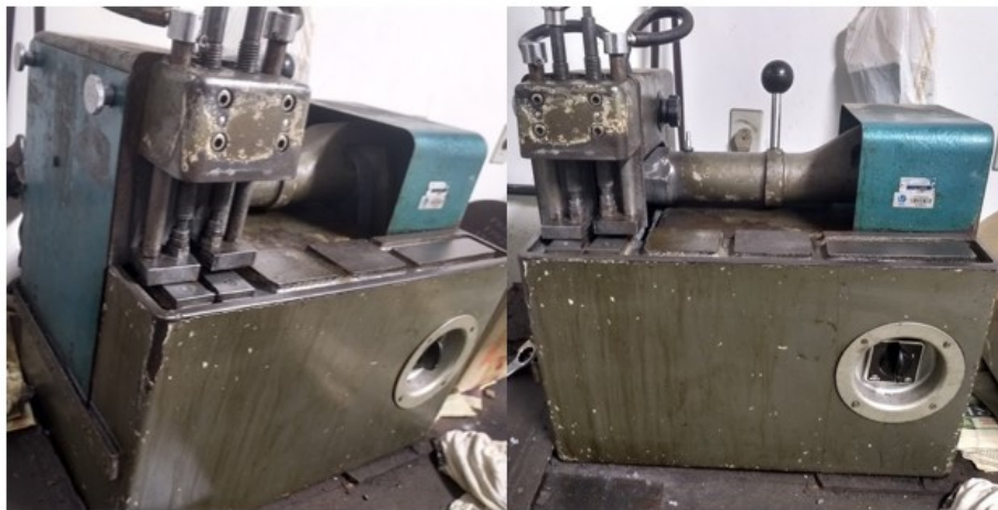
Figura 16 – Cortadora Metalográfica do laboratório de tribologia.
