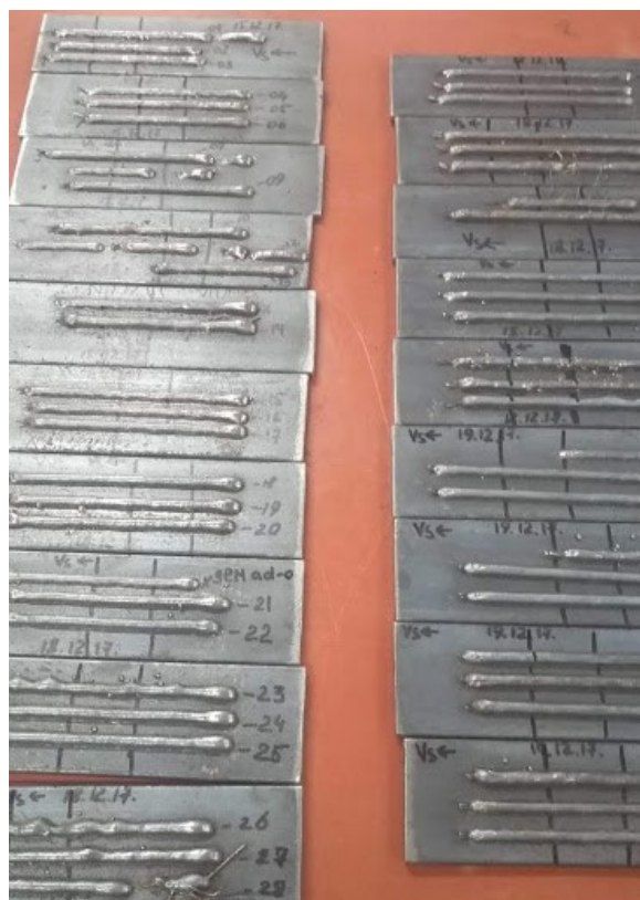
Figura 20 – cordões depositados durante a etapa experimental.
