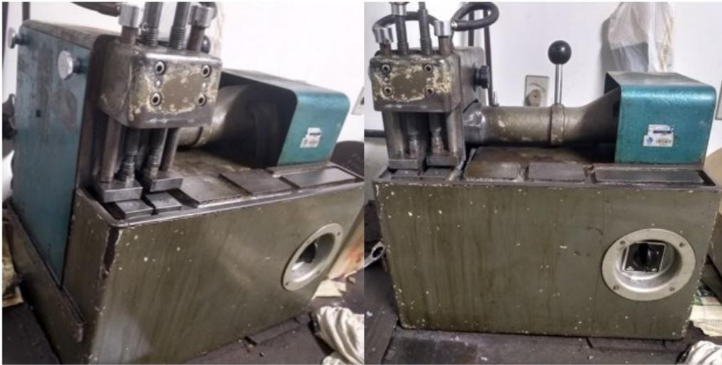
Figura 18 - Cortadora Metalográfica do laboratório de tribologia.
