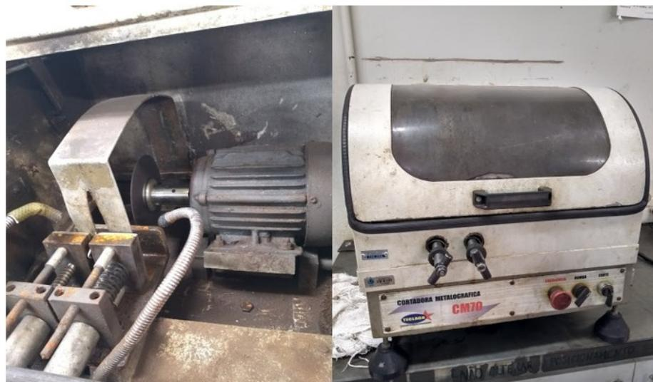
Figura 17 - Cortadora Metalográfica do laboratório de soldagem.
