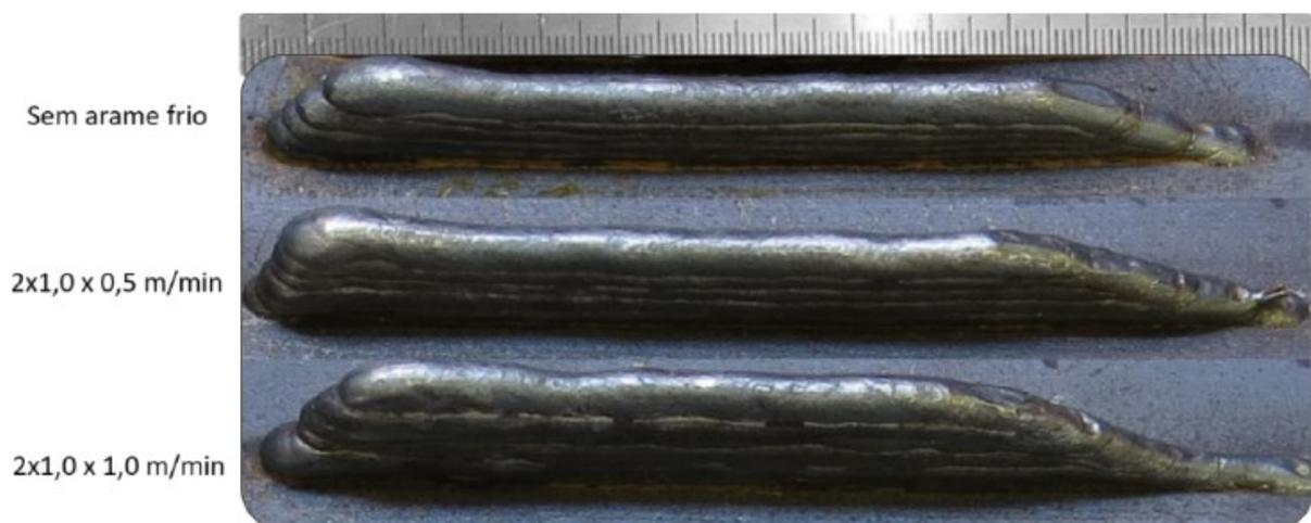
Figura 21 - Aspecto superficial das paredes depositadas (KOVALENKO, 2019).
