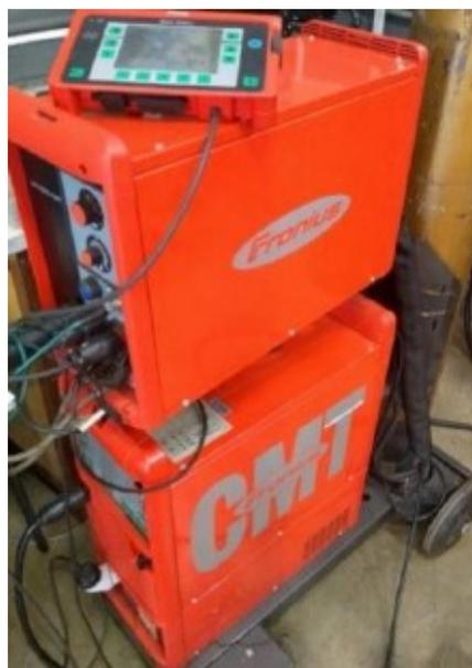
Figura 11 - Fonte de soldagem TPS 5000, Fronius com alimentador de arame.
