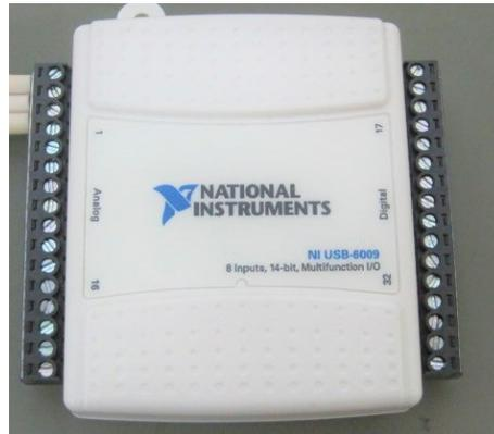
Figura 16 - Placa de aquisição de sinais - NI USB-6009.
