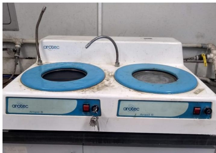
Figura 19 - Lixadeira Metalográfica dupla.
