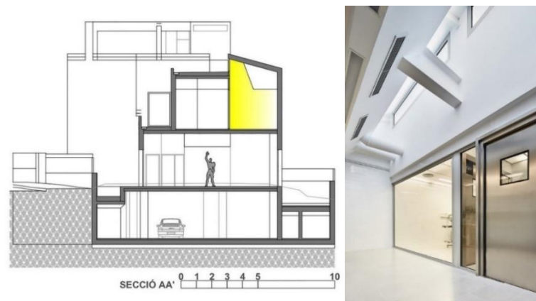
Figura 24: Clarabóias de iluminação na ala cirúrgica
