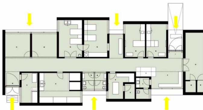
Figura 15: Indicação de cheios e vazios que permitem a entrada de luz natural no interior da edificação
