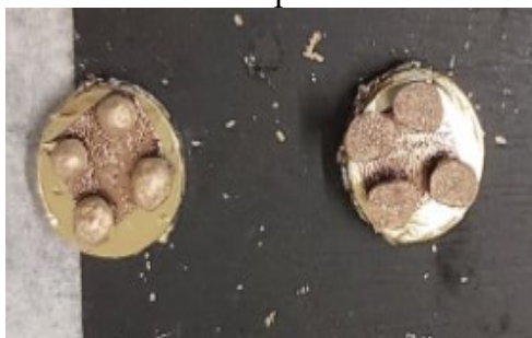
Figura 17 - Amostras de ureia pulverizadas com ouro (Autor)
