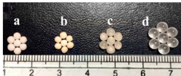
Figura 6 - Expansão do revestimento de ureia revestida com poliuretano a base de óleo rícino após imersão em água deionizada [30]
