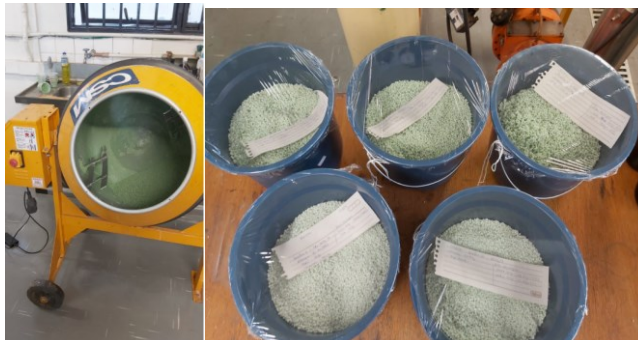
Figura 16 - Misturador e armazenamento de ureia revestida com poliuretano
