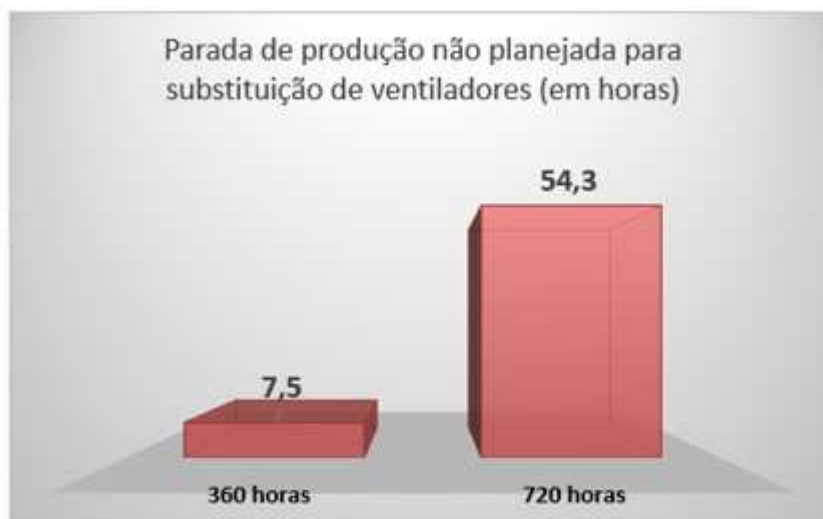
Figura 16 – Gráfico comparativo do tempo de parada de produção não planejada entre os planos de preditiva para substituição dos ventiladores
