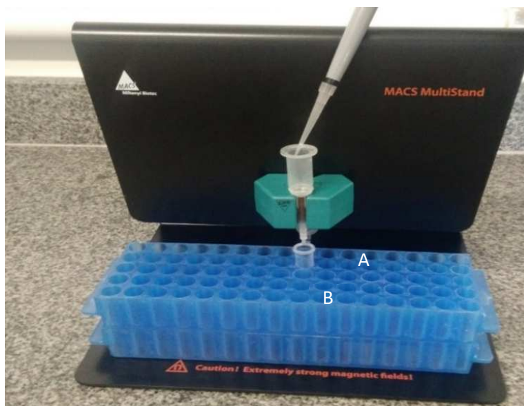
Figura 14 - Coluna de separação magnética MiniMACS (Miltenyi Biotec, Alemanha) utilizada na separação de espermatozoides em bovinos. A - imã magnético, B - coluna de filtração.
