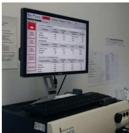
Figura 7 – Aparelho CASA utilizado na análise de motilidade espermática de bovinos e gatos.
