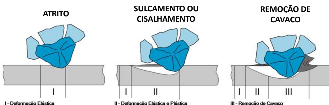
Figura 2.4 – Etapas de formação do cavaco na retificação (TEIXEIRA et al., 2021, adaptado).
