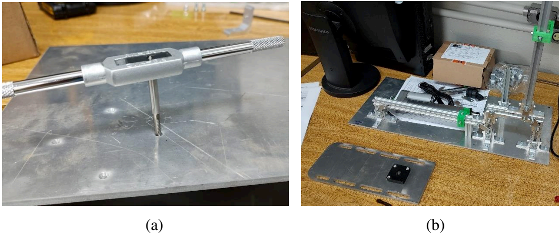
Figura 3.16 – Construção do protótipo. (a) rosca interna; (b) montagem parcial do protótipo (Autoria própria).
