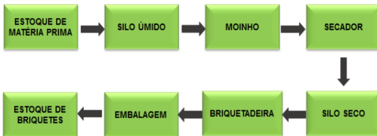
Figura 6 - Fluxograma do processo de briquetagem
