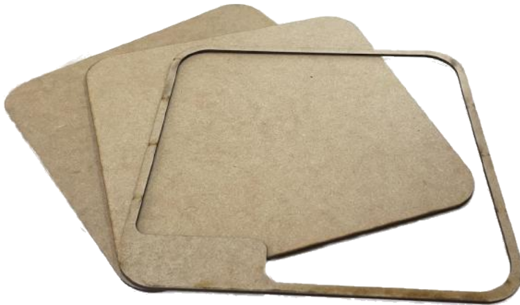
Figura 35 - Placas de MDF após o corte a laser
