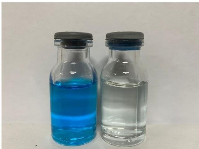
**Figura 31:** Resultado do processo de degradação fotocatalítica após 120 min: 0,5g  $\text{Nb}_2\text{O}_5$  HI, pH 5, concentração inicial de corante  $10 \text{ mg L}^{-1}$ .
