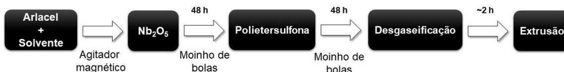
**Figura 8:** Fluxograma com as etapas realizadas para a fabricação da suspensão cerâmica.
