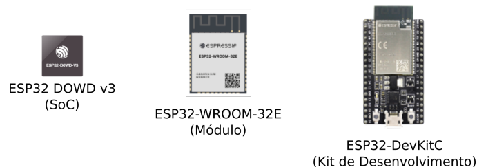
Figura 6 – Distinção entre os componentes baseados no ESP32.
