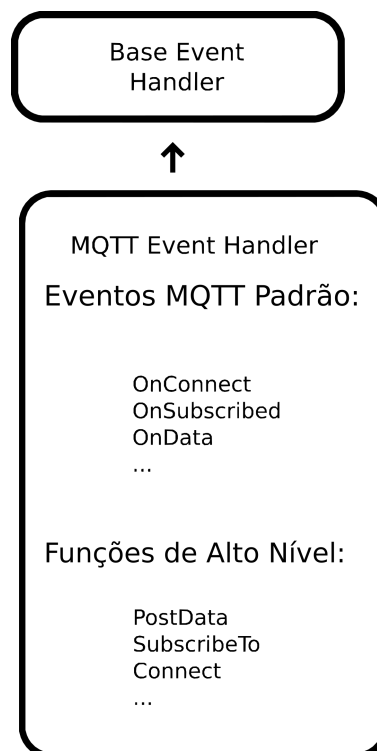
Figura 10 – Diagrama esquemático da classe MQTT.
