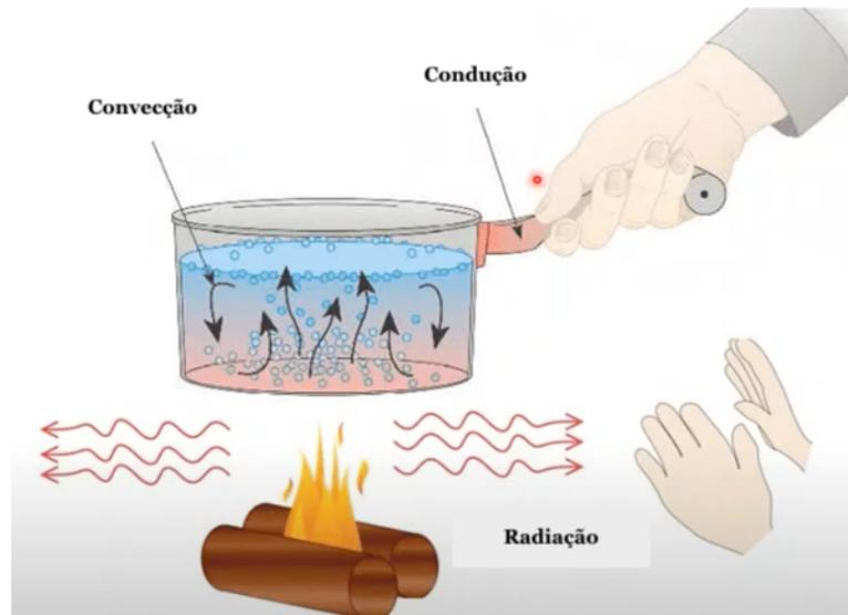
Figura 1. As três formas de transferência de calor
