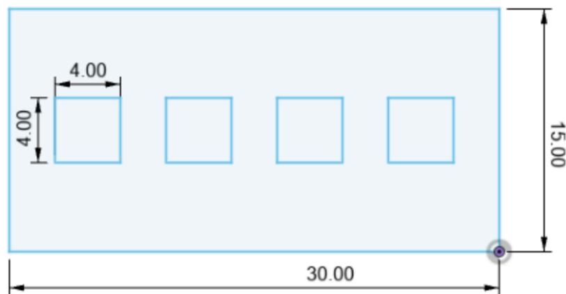
Figura 8. Exemplo da distribuição das inclusões na placa
